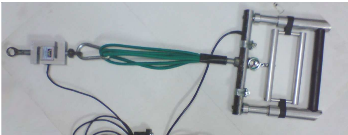
Figura 17. Dinamômetro de prensão manual acoplado a uma célula de carga comercial.
