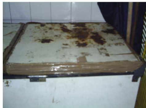
Foto 19. Freezer com ferrugem.
