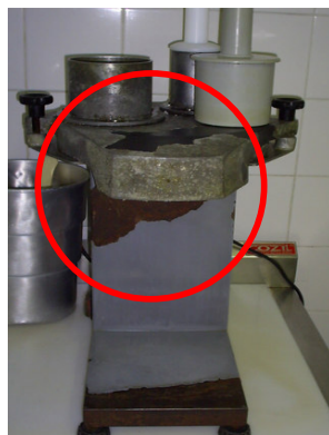
Fotos 9 e 10. Equipamentos com ferrugem.
