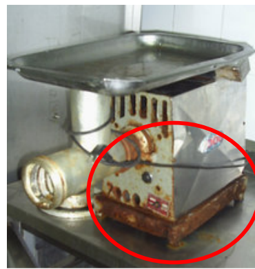
Fotos 9 e 10. Equipamentos com ferrugem.
