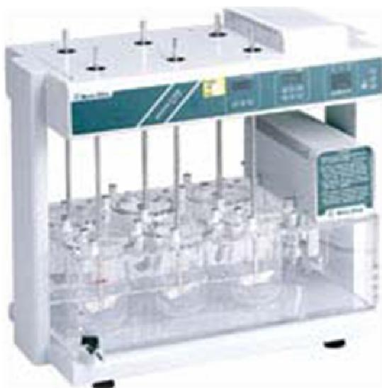
Figura 20 - Aparelho de dissolução.
