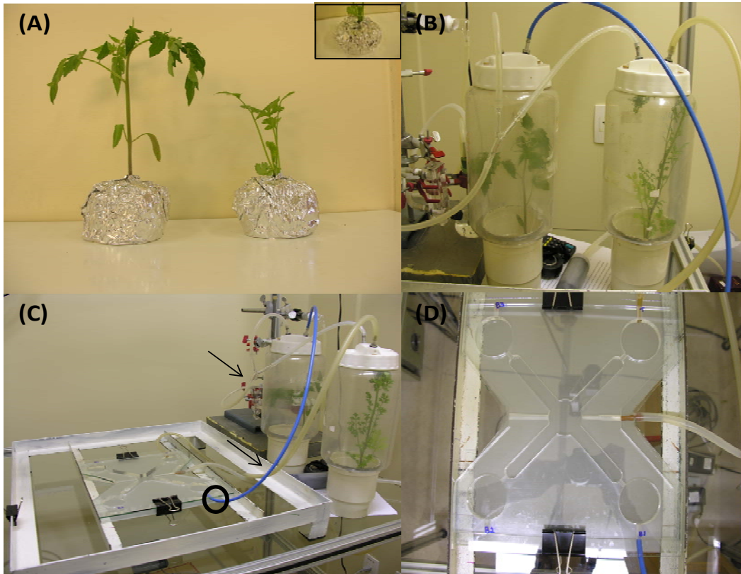
Figura 1.1: Sequência de montagem do experimento em olfatômetro de múltipla escolha do tipo X. (A) isolamento da parte aérea das plantas com papel alumínio, (B) plantas de interesse dentro de cubas herméticas para utilização de seus voláteis no bioensaio, (C) conexão das cubas herméticas com a arena de observação e (D) Placas de acrílico montadas para formação da arena de observação.
