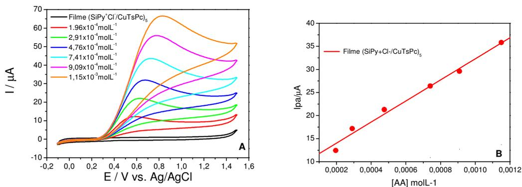
**Figura 42:** Voltamogramas cíclicos para o filme automontado (A)  $\text{SiPy}^+\text{Cl}^-/\text{CuTsPc}$  com  $v = 50 \text{ mVs}^{-1}$  para diferentes concentrações de AA, na faixa de  $1,96 \times 10^{-4}$  a  $1,31 \times 10^{-3} \text{ molL}^{-1}$  e (B) correlação entre  $I_{\text{pA}}$  e a concentração de AA para o eletrodo  $\text{SiPy}^+\text{Cl}^-/\text{CuTsPc}$ , no eletrólito  $\text{HCl } 1 \times 10^{-3} \text{ molL}^{-1}$  ( $\text{pH}=3,0$ ).
