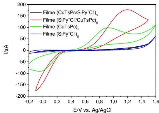
**Figura 29:** Voltamogramas cíclicos para os filmes automontados de CuTsPc/SiPy<sup>+</sup>Cl<sup>-</sup> e SiPy<sup>+</sup>Cl<sup>-</sup>/CuTsPc e para os filmes de CuTsPc e SiPy<sup>+</sup>Cl<sup>-</sup> na presença de [DA]= $1 \times 10^{-3} \text{ molL}^{-1}$ . com velocidade de varredura de:  $50 \text{ mV s}^{-1}$ , em HCl  $1 \times 10^{-3} \text{ molL}^{-1}$  e pH=3,0.
