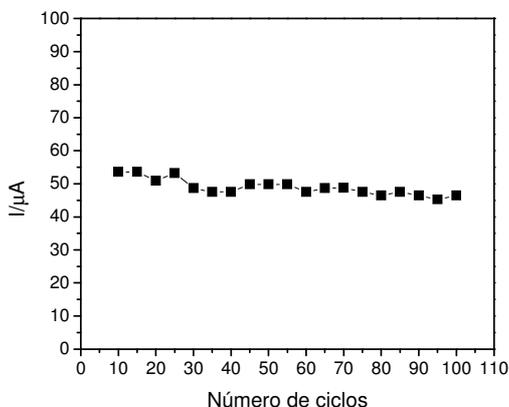
**Figura 37:** Correlação entre a corrente de pico anódica e o número de ciclos para o filme SiPy<sup>+</sup>Cl<sup>-</sup>/CuTsPc, em  $1 \times 10^{-3} \text{ molL}^{-1}$  de DA, no eletrólito de HCl  $1 \times 10^{-3} \text{ molL}^{-1}$  pH 3,0,  $v=50 \text{ mV/s}$ .
