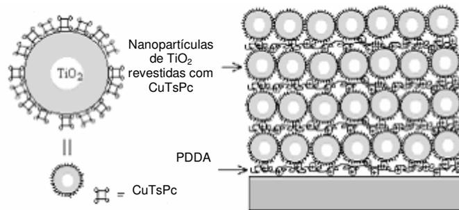
**Figura 5:** Esquema da deposição dos filmes PDDA/ $\text{TiO}_2$  revestido com CuTsPc.
