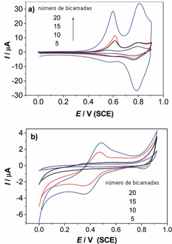
**Figura 14:** Voltamogramas cíclicos para (a) PAH/NiTsPc e (b) PAH/FeTsPc com diferentes números de bicamadas. Eletrólito suporte: solução de HCl  $0,1 \text{ molL}^{-1}$ ,  $\nu=50 \text{ mVs}^{-1}$ ,  $25^{\circ}\text{C}$ .
