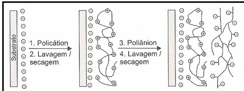
**Figura 4:** Representação esquemática da fabricação de filmes automontados pela técnica Layer-by-Layer<sup>[10]</sup>.
