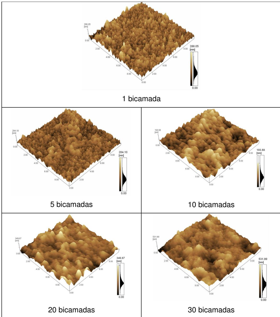
**Figura 27:** Imagens de AFM para o filme automontado de SiPy<sup>+</sup>Cl<sup>-</sup>/CuTsPc contendo diferentes números de bicamadas, como indicado. Janela de varredura de 10x10µm.
