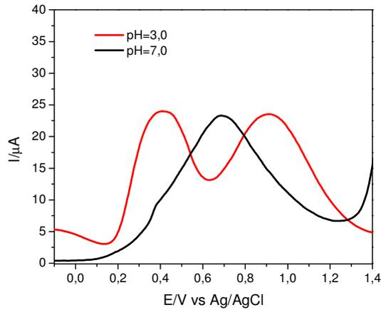
**Figura 47:** Voltamogramas de pulso diferencial para o filme automontado de SiPy<sup>+</sup>Cl<sup>-</sup>/CuTsPc na presença simultânea de DA e AA, pH 3,0 e 7,0. Condições:  $E_{\text{pulso}} = 0,05 \text{ V}$ ,  $v=0,005 \text{ Vs}^{-1}$  e tempo de pulso= 0,07 s.
