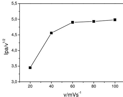
**Figura 32:** Gráficos de  $I_{pa}/v^{1/2}$  em função da velocidade de varredura do eletrodo modificado SiPy<sup>+</sup>Cl<sup>-</sup>/CuTsPc. Dados obtidos dos voltamogramas cíclicos registrados em diferentes velocidades de varredura (20, 40, 60, 80 e 100 mVs<sup>-1</sup>) em solução de HCl  $1 \times 10^{-3}$  molL<sup>-1</sup> (pH 3,0) contendo  $1,0 \times 10^{-3}$  molL<sup>-1</sup> de dopamina.
