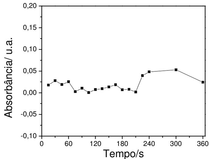
**Figura 22:** Acompanhamento do crescimento do filme a partir da banda com absorvância máxima (em 617nm) em função do tempo de imersão na solução para formação do filme SiPy<sup>+</sup>Cl<sup>-</sup>/CuTsPc em pH 8.
