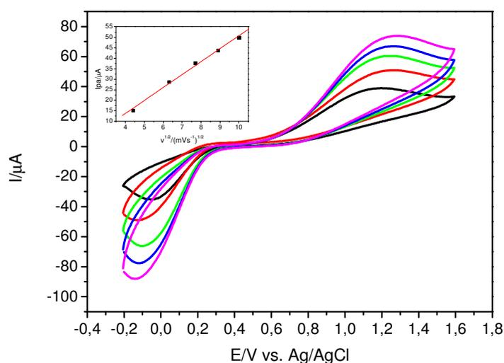
**Figura 34:** Voltamogramas cíclicos com diferentes velocidades de varredura (20, 40, 60, 80 e  $100 \text{ mVs}^{-1}$ ) em filmes automontados contendo 5 bicamadas de SiPy<sup>+</sup>Cl<sup>-</sup>/CuTsPc. *Inset* mostra a relação linear entre  $I_{pA}$  e  $v^{1/2}$  na presença de  $1,0 \times 10^{-3} \text{ molL}^{-1}$  de DA.
