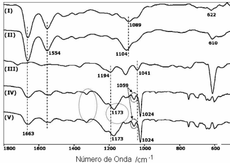
**Figura 8:** Espectro de FTIR modo transmissão para os filmes *casting* I) PAMAM, II) PAMAM-NT, III) NiTsPc e para os filmes LbL de IV) PAMAM/NiTsPc, V) PAMAM-NT/NiTsPc contendo 15 bicamadas
