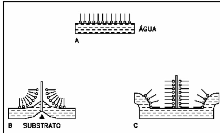
**Figura 3:** Representação esquemática do método Langmuir-Blodgett para a fabricação de filmes. A) orientação das moléculas na subfase; B) transferência das monocamadas para um substrato a partir da retirada do mesmo (deposição da 1ª monocamada) e C) imersão do substrato e deposição da 2ª monocamada<sup>[8]</sup>.
