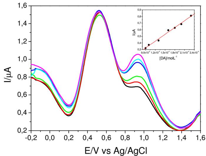
**Figura 48:** Voltamogramas de pulso diferencial para o filme automontado SiPy<sup>+</sup>Cl<sup>-</sup>/CuTsPc na presença de uma concentração fixa de [AA]=  $1 \times 10^{-3} \text{ molL}^{-1}$ , em diferentes concentrações de DA, na faixa de  $9 \times 10^{-5}$  a  $2 \times 10^{-4} \text{ molL}^{-1}$  em HCl  $1 \times 10^{-3} \text{ molL}^{-1}$  (pH 3).  $E_{\text{pulso}} = 0,05 \text{ V}$ ,  $v = 0,005 \text{ Vs}^{-1}$  e tempo de pulso = 0,07 s.
