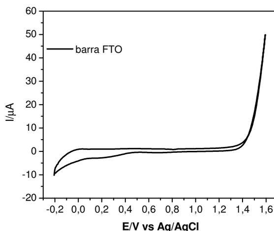
**Figura 28:** Voltamograma cíclico para o substrato FTO, em HCl 1x10<sup>-3</sup> molL<sup>-1</sup> a 50 mVs<sup>-1</sup>.
