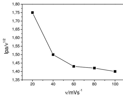
**Figura 40:** Gráficos de  $I_{pa}/v^{1/2}$  em função da velocidade de varredura do eletrodo modificado SiPy<sup>+</sup>Cl<sup>-</sup>/CuTsPc. Dados obtidos dos voltamogramas cíclicos registrados em diferentes velocidades de varredura (20, 40, 60, 80 e 100  $mVs^{-1}$ ) em solução de HCl  $1 \times 10^{-3} molL^{-1}$  (pH 3,0) contendo  $1,0 \times 10^{-3} molL^{-1}$  de AA.
