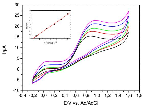
**Figura 41:** Voltamogramas cíclicos com diferentes velocidades de varredura (20, 40, 60, 80 e 100  $\text{mVs}^{-1}$ ) em filmes automontados contendo 5 bicamadas de  $\text{SiPy}^+\text{Cl}^-/\text{CuTsPc}$ . *Inset* mostra a relação linear entre  $I_{\text{pA}}$  e  $v^{1/2}$  na presença de  $1,0 \times 10^{-3} \text{ molL}^{-1}$  de AA.
