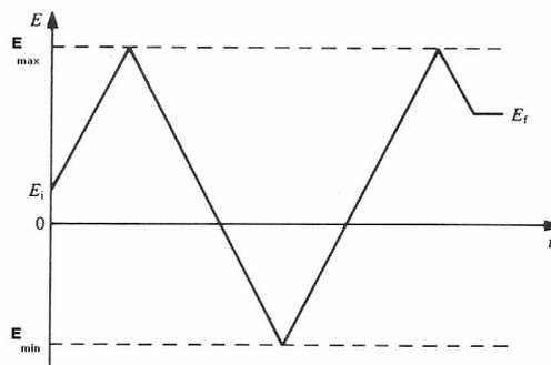
**Figura 12:** Variação do potencial aplicado com o tempo em voltametria cíclica, mostrando o potencial inicial,  $E_i$ , o potencial final,  $E_f$ , os potenciais máximo,  $E_{m\acute{a}x}$ , e mínimo,  $E_{m\acute{i}n}$ <sup>[49]</sup>.
