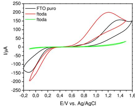
**Figura 31:** Voltamogramas cíclicos para detecção de  $[DA] = 1 \times 10^{-3} \text{ molL}^{-1}$ , em  $\text{HCl } 1 \times 10^{-3} \text{ molL}^{-1}$  a  $50 \text{ mVs}^{-1}$ , para o substrato FTO e para os filmes contendo 5 bicamadas:  $\text{SiPy}^+\text{Cl}^-/\text{CuTsPc}$  e  $\text{CuTsPc}/\text{SiPy}^+\text{Cl}^-$
