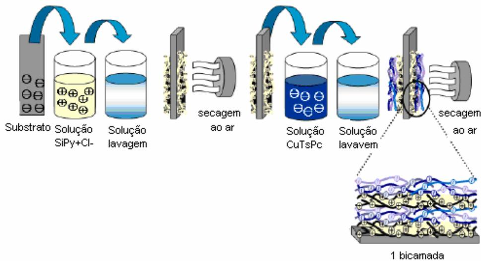
**Figura 20:** Representação esquemática da preparação de 1 bicamada do filme  $\text{SiPy}^+\text{Cl}^-/\text{CuTsPc}$  segundo<sup>[4]</sup>.
