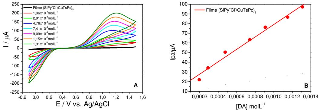
**Figura 35:** Voltamogramas cíclicos para os filmes automontados (A)  $\text{SiPy}^+\text{Cl}^-/\text{CuTsPc}$  com  $v = 50 \text{ mVs}^{-1}$  para diferentes concentrações de DA, na faixa de  $1,96 \times 10^{-4}$  a  $1,31 \times 10^{-3} \text{ molL}^{-1}$  e (B) correlação entre  $I_{pa}$  e a concentração de DA para o eletrodo  $\text{SiPy}^+\text{Cl}^-/\text{CuTsPc}$ , no eletrólito  $\text{HCl } 1 \times 10^{-3} \text{ molL}^{-1}$  ( $\text{pH}=3,0$ ).
