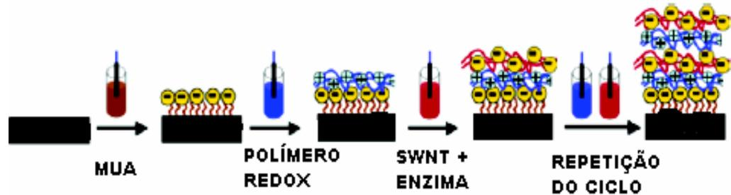
**Figura 6:** Esquema de deposição do filme LBL. Eletrodo de ouro foi primeiramente funcionalizado negativamente com o ácido 11-mercaptopropiônico (MUA), e, em seguida, automontado alternativamente com as soluções de polímero redox carregadas positivamente e Enzima/ SWNT carregado negativamente.
