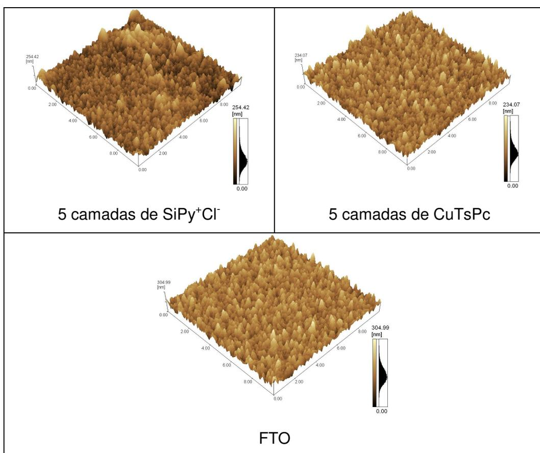
**Figura 26:** Imagens de AFM para o substrato FTO e dos precursores  $\text{SiPy}^+\text{Cl}^-$  e  $\text{CuTsPc}$ . Janela de varredura de  $10 \times 10 \mu\text{m}$ .
