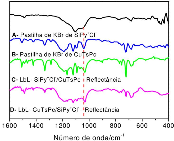
**Figura 25:** Espectros de FTIR para os polieletrólitos (A)  $\text{SiPy}^+\text{Cl}^-$ , (B)  $\text{CuTsPc}$  (modo transmitância) e para os filmes automontados de (C)  $\text{SiPy}^+\text{Cl}^-/\text{CuTsPc}$ , (D)  $\text{CuTsPc}/\text{SiPy}^+\text{Cl}^-$  (modo reflectância).
