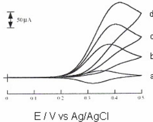
**Figura 15:** Voltamogramas cíclicos do ácido ascórbico sobre o eletrodo contendo os íons  $\text{Fe}(\text{CN})_6^{3-}$  confinado no filme  $(\text{PAH-CMC})_5$ , em diferentes concentrações: (a) 0 mM; (b) 5 mM; (c) 10 mM e (d) 15 mM em tampão Tris-HCl 10 mM contendo 150 mM NaCl e  $v = 0,05 \text{ V/s}$ <sup>[35]</sup>.
