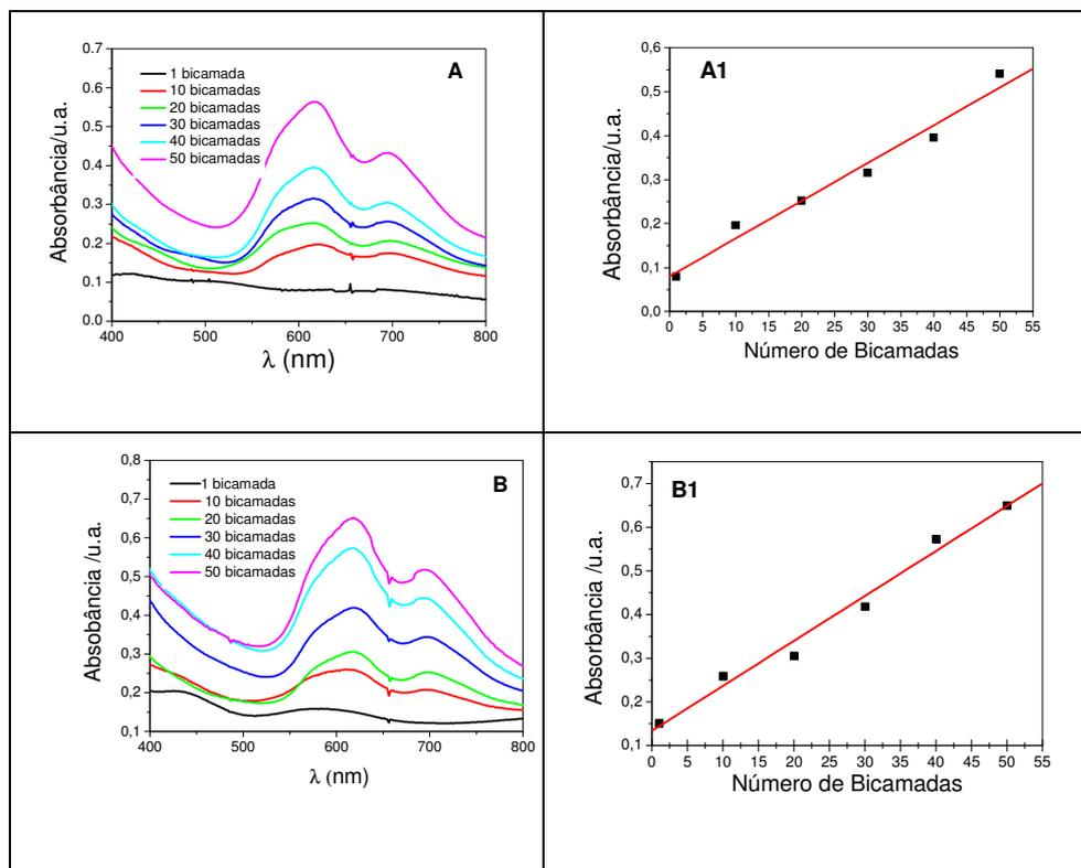
**Figura 23:** Espectros de absorção na região do visível para filmes automontados de (A) CuTsPc/SiPy<sup>+</sup>Cl<sup>-</sup>, (B) SiPy<sup>+</sup>Cl<sup>-</sup>/CuTsPc e a relação entre a absorbância da banda em 617 nm e 618 nm em função do número de bicamadas para os sistemas CuTsPc/SiPy<sup>+</sup>Cl<sup>-</sup> (A.1) e SiPy<sup>+</sup>Cl<sup>-</sup>/CuTsPc (B.1), respectivamente.
