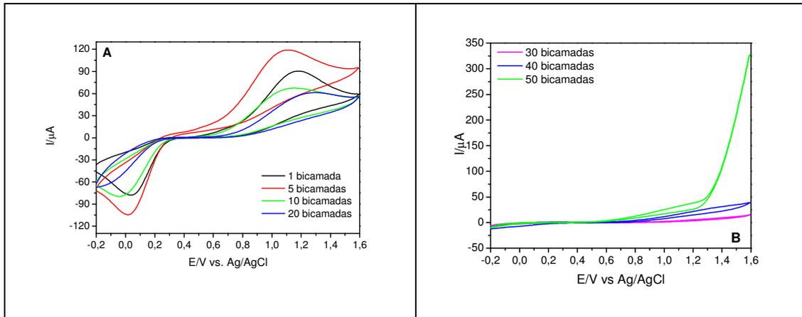
**Figura 30:** Voltamogramas cíclicos para o filme  $\text{SiPy}^+\text{Cl}^-/\text{CuTsPc}$  contendo diferentes números de bicamadas.  $v=50 \text{ mV s}^{-1}$  e  $[\text{DA}]=1 \times 10^{-3} \text{ molL}^{-1}$ .
