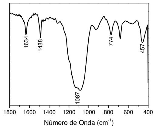
**Figura 24:** Espectro de FTIR do polícatión  $\text{SiPy}^+\text{Cl}^-$  em pastilha de KBr (modo transmissão)
