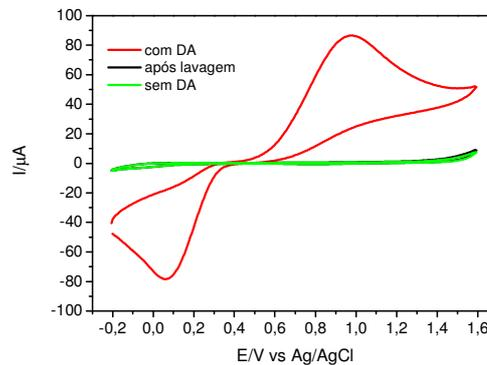
**Figura 36:** Resposta eletroquímica do eletrodo de  $(\text{SiPy}^+\text{Cl}^-/\text{CuTsPc})_5$ , após lavagem  $v = 50 \text{ mVs}^{-1}$ .
