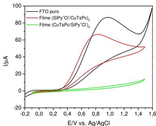
**Figura 38:** Voltamogramas cíclicos para detecção de  $[AA] = 1 \times 10^{-3} \text{ molL}^{-1}$ , em  $\text{HCl } 1 \times 10^{-3} \text{ molL}^{-1}$  a  $50 \text{ mVs}^{-1}$ , para o substrato FTO e para os filmes contendo 5 bicamadas:  $\text{SiPy}^+\text{Cl}^-/\text{CuTsPc}$  e  $\text{CuTsPc}/\text{SiPy}^+\text{Cl}^-$
