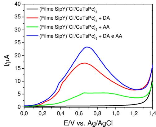
**Figura 45:** Voltamogramas de pulso diferencial para o filme automontado de  $\text{SiPy}^+\text{Cl}^-/\text{CuTsPc}$  na presença de DA e AA, com concentração fixa de  $1 \times 10^{-3}$  em tampão fosfato (pH 7). Condições:  $E_{\text{pulso}} = 0,05 \text{ V}$ ,  $v = 0,005 \text{ Vs}^{-1}$  e tempo de pulso =  $0,07 \text{ s}$ .
