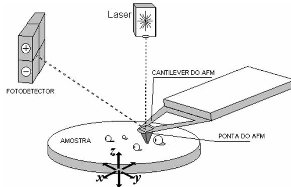
**Figura10:** Esquema de funcionamento do Microscópio de Força Atômica.
