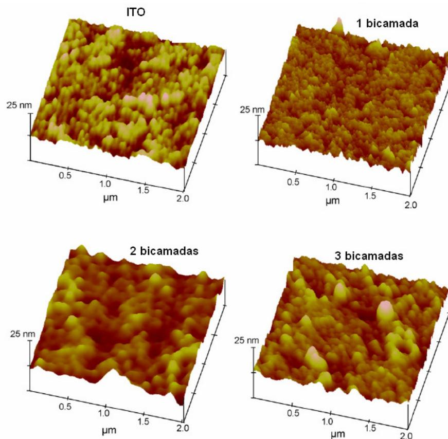
**Figura 11:** Imagens de AFM 3D das topografias do substrato ITO e do filme automontado (PVS/PAMAM-Au), contendo de 1 a 3 bicamadas<sup>[42]</sup>.
