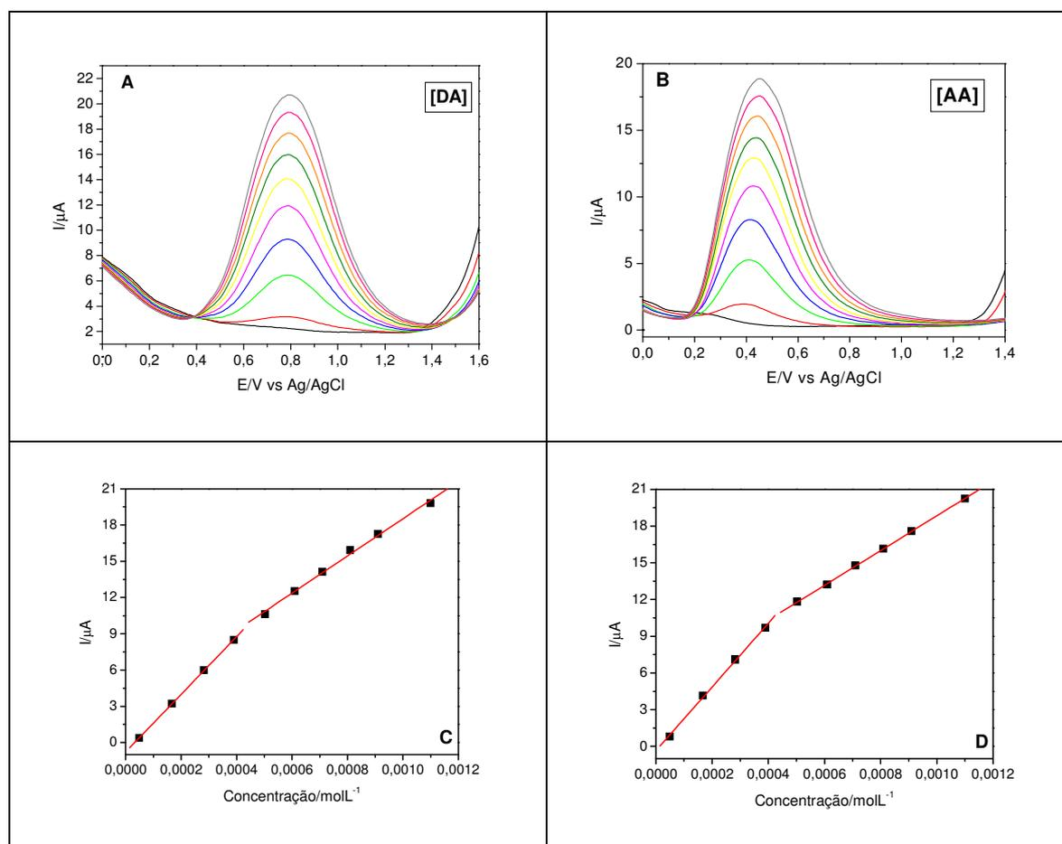
**Figura 44:** Voltamogramas de pulso diferencial para o filme automontado SiPy $^{+}$ Cl $^{-}$ /CuTsPc com  $v = 20$  mVs $^{-1}$  na presença de DA (A) e AA (B), na faixa de concentração de  $9 \times 10^{-5}$  a  $2, \times 10^{-4}$  molL $^{-1}$  em HCl  $1 \times 10^{-3}$  molL $^{-1}$  (pH 3). Curvas de calibração para DA (A1) e AA (B1). Condições:  $E_{\text{pulso}} = 0,05$  V,  $v = 0,005$  Vs $^{-1}$  e tempo de pulso = 0,07 s.
