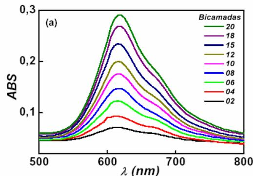
**Figura 7:** Espectros de absorção na região do UV-vis para filmes automontados de QNiTsPc em pH 4, com diferentes números de bicamadas<sup>[4]</sup>.
