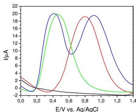
**Figura 46:** Voltamogramas de pulso diferencial para o filme automontado de  $\text{SiPy}^+\text{Cl}^-/\text{CuTsPc}$  na presença de DA e AA, com concentração fixa de  $1 \times 10^{-3}$  em  $\text{HCl } 1 \times 10^{-3} \text{ mol L}^{-1}$  (pH 3). Condições:  $E_{\text{pulso}} = 0,05 \text{ V}$ ,  $v = 0,005 \text{ Vs}^{-1}$  e tempo de pulso =  $0,07 \text{ s}$ .
