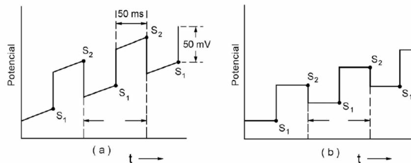
**Figura 16:** Representação esquemática da aplicação de potencial em função do tempo em voltametria de pulso diferencial. (a), Em instrumentos analógicos; (b), Em instrumentos digitais. A corrente é mostrada em  $S_1$  e  $S_2$  e a diferença entre elas é que é registrada:  $I = I_{S_2} - I_{S_1}$
