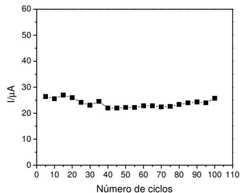
**Figura 43:** Correlação entre a corrente de pico anódica e o número de ciclos para o filme SiPy<sup>+</sup>Cl<sup>-</sup>/CuTsPc, em  $1 \times 10^{-3}$  molL<sup>-1</sup> de AA, no eletrólito de HCl  $1 \times 10^{-3}$  molL<sup>-1</sup> pH 3,0,  $v = 50$  mV/s.
