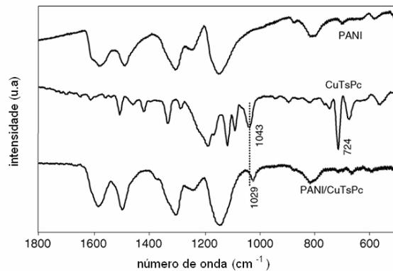
**Figura 9:** Espectro de FTIR para os filmes *casting* de PANI e CuTsPc e para o filme LbL PANI/CuTsPc contendo 20 bicamadas<sup>[25]</sup>.
