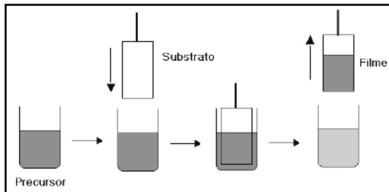
**Figura 1:** Representação esquemática do processo de obtenção de filmes por *dip coating*<sup>[9]</sup>.
