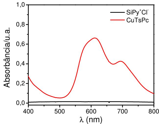
**Figura 21:** Espectro de absorção na região do UV-VIS das soluções dos polieletrólitos utilizados para a fabricação dos filmes automontados,  $\text{SiPy}^+\text{Cl}^-$  e  $\text{CuTsPc}$  em uma concentração 2 mg/mL e  $\text{pH}=8,0$ .
