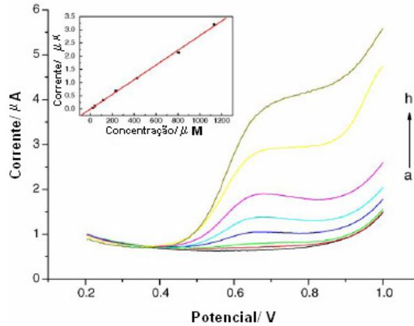
**Figura 17:** Voltamogramas de pulso diferencial do eletrodo (PDDA/MWNT)<sub>8</sub>/GC em soluções contendo diferentes concentrações de cisteína (a) 0,0  $\mu\text{molL}^{-1}$ , (b) 20  $\mu\text{molL}^{-1}$ , (c) 40  $\mu\text{molL}^{-1}$ , (d) 117  $\mu\text{molL}^{-1}$ , (e) 233  $\mu\text{molL}^{-1}$ , (f) 423  $\mu\text{molL}^{-1}$ , (g) 805  $\mu\text{molL}^{-1}$  e (h) 1300  $\mu\text{molL}^{-1}$ . Eletrólito suporte: solução tampão fosfato 0,16  $\text{molL}^{-1}$  (pH 7,4) [53].
