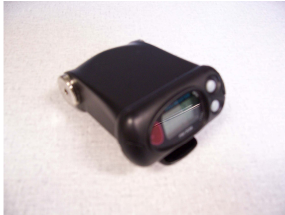
FIG. 2.9: Dosimetro pessoal pager, do tipo Geiger-Müller, modelo PM1703GN do Fabricante Thermo Electron Corporation
