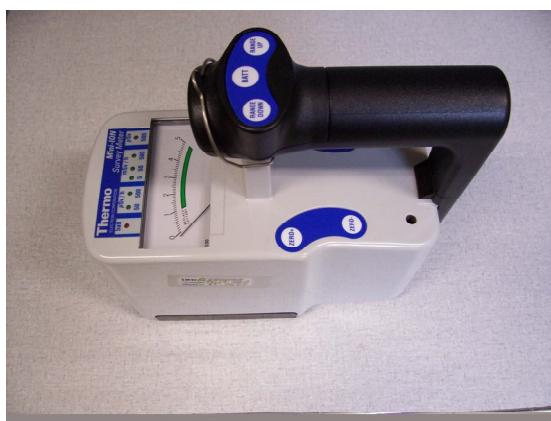
FIG. 2.7: Câmara de Ionização modelo 2130 Mini-ION do fabricante Thermo Electron Corporation
