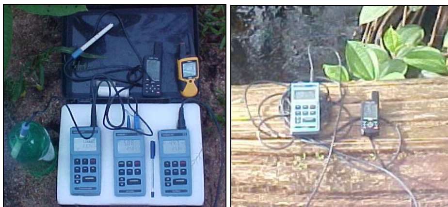
Fig. 5.3 - Aparelhos utilizados na medição de parâmetros (Condutivímetro, pHmetro e Oxímetro) em campo.
