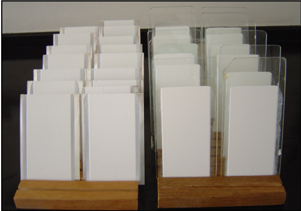
Figura 33 - Painéis de vidro, alumínio e folha de flandres submetidas à microondas
