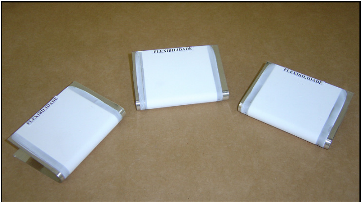
Figura 40 - Flexibilidade: fissuras, descolamento
