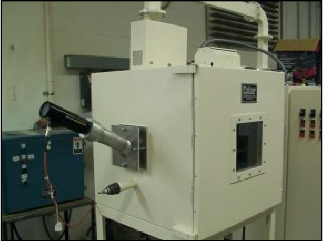
Figura 22 - Forno de microondas de batelada para sinterização Fonte: (34)
