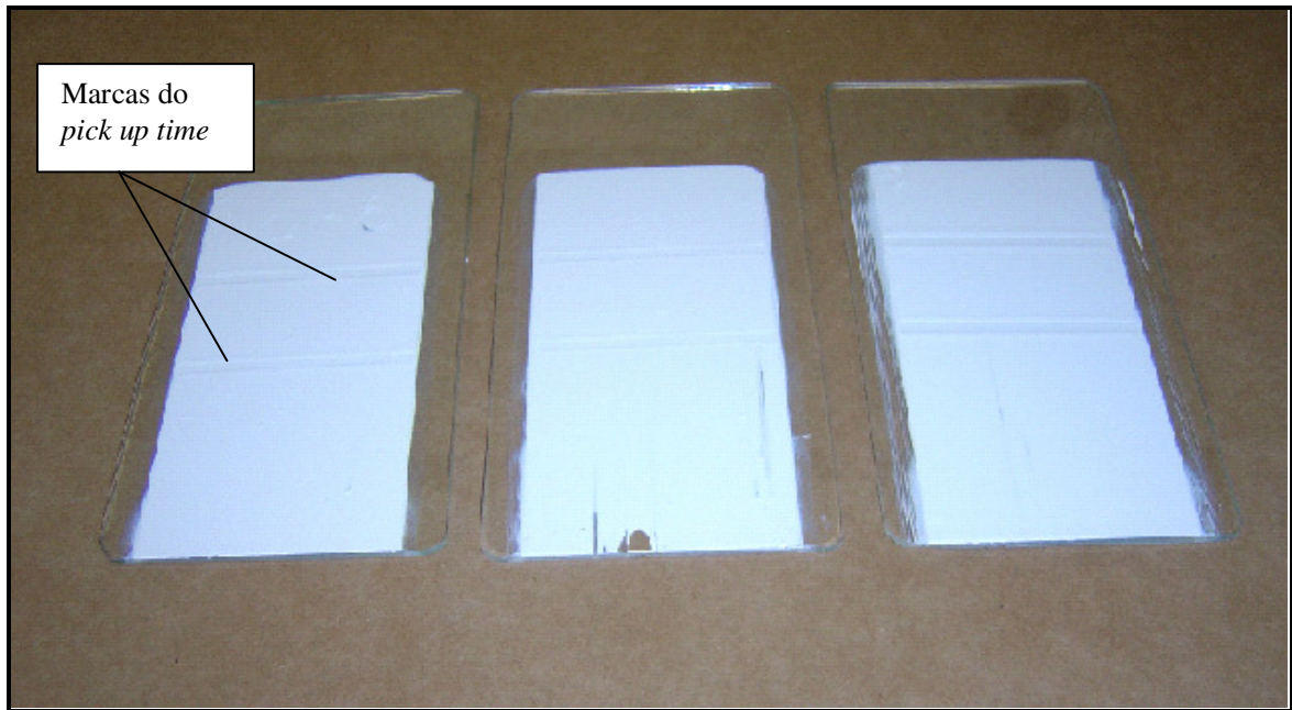
Figura 35 - Tempo de secagem no pick up time – extensor de 0,4 mm
