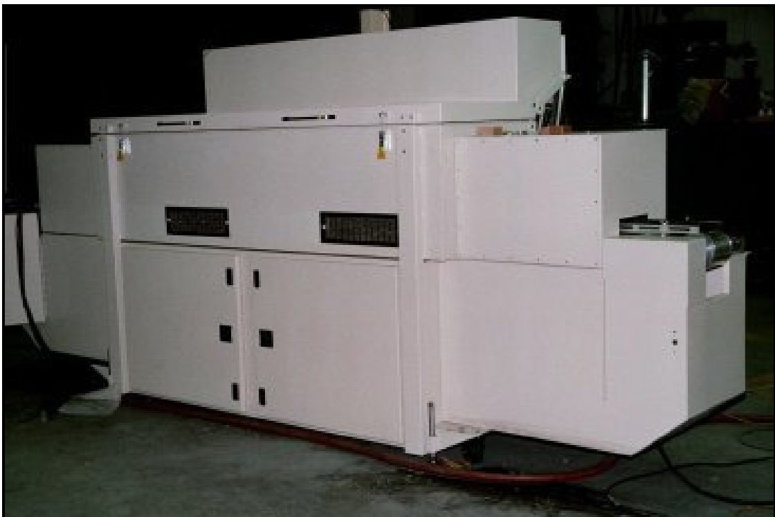
Figura 23 - Forno de microondas contínuo para sinterização Fonte: (34)
