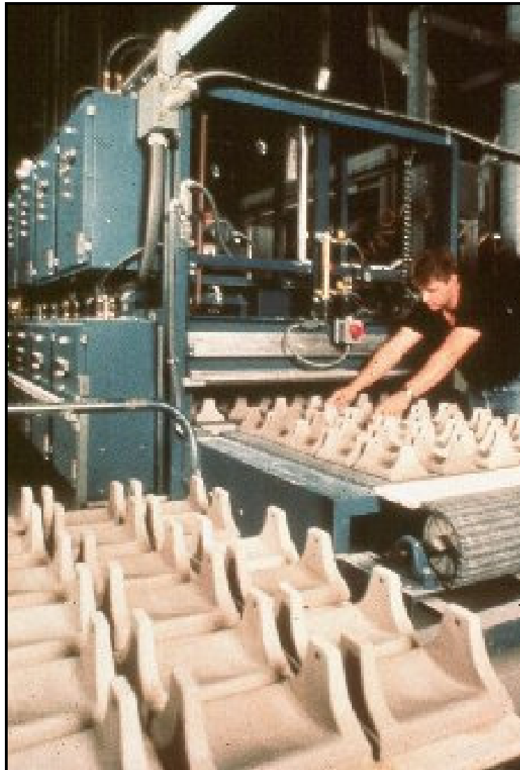
Figura 24 - Forno de microondas contínuo para cerâmica Fonte: (34)
