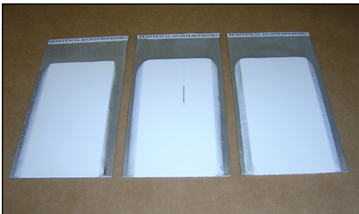
Figura 44 - Resistência ao intemperismo (400h) – cor e integridade
