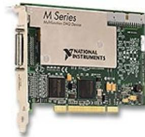
Figura 4.5 Placa de Aquisição NI PCI-6251
