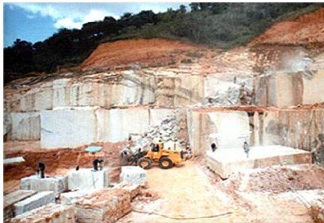
**Figura 18.** Retirada dos blocos de granito
