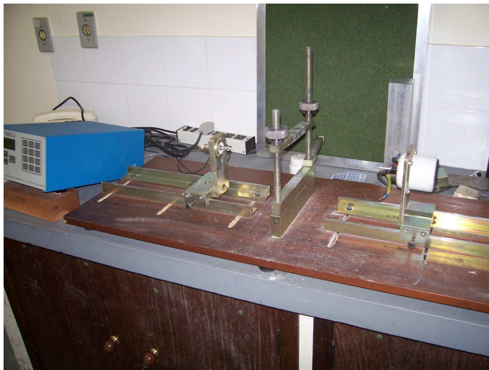
Figura 2.32– Foto do equipamento ERUDITE MKII para determinação do módulo de elasticidade dinâmico.
