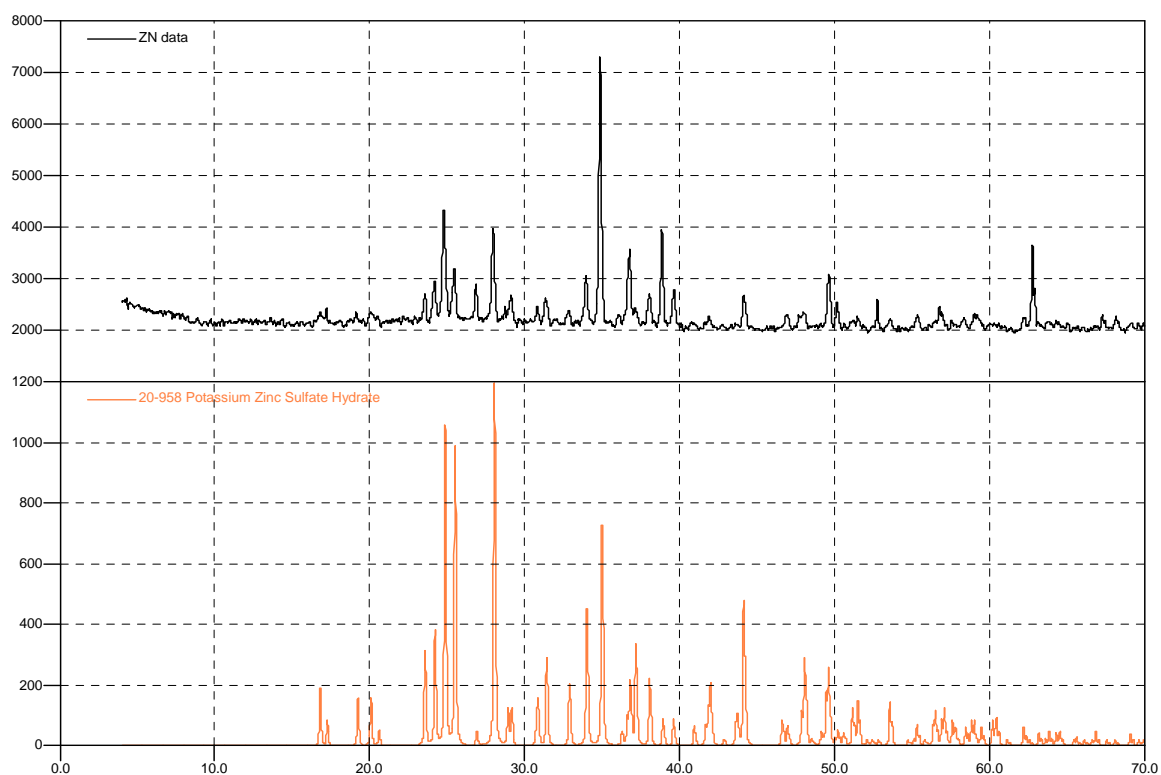
Figura 9 - Difratograma obtido para ZnK_2(SO_4)_2 \cdot 6H_2O (acima) e difratograma padrão (abaixo), tubo de Co
