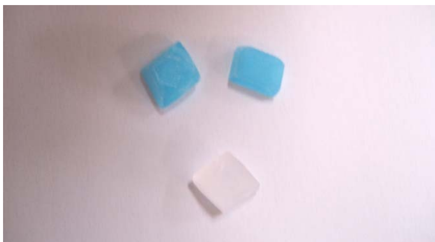
Figura 2 - Cristais de \text{Cu}(\text{NH}_4)_2(\text{SO}_4)_2 \cdot 6\text{H}_2\text{O} (azuis) e \text{Zn}(\text{NH}_4)_2(\text{SO}_4)_2 \cdot 6\text{H}_2\text{O} (incolor)
