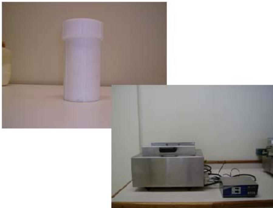
Figura 4.1 (a) Autoclave de teflon utilizada na síntese dos materiais mesoporos; (b) Forno utilizado para manter as autoclaves durante os cinco dias de síntese.
