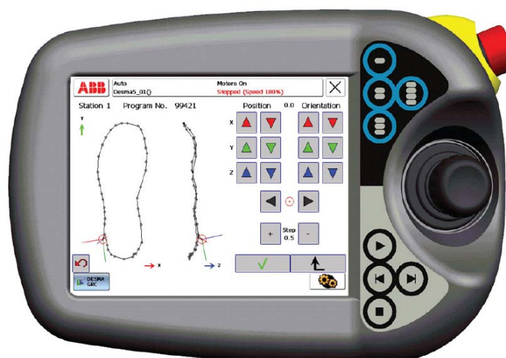
Figura 3.4 - Controle para programação de robôs ABB Flex-pendant (ABB, 2004).
