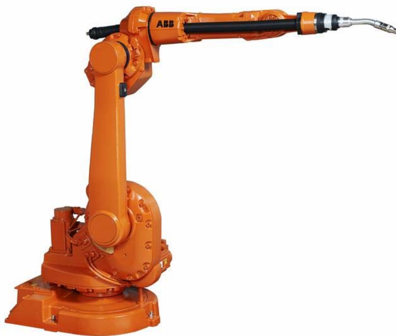
Figura 2.3. Exemplo de robô de seis eixos (seis graus de liberdade) para solda (ABB, 2008).
