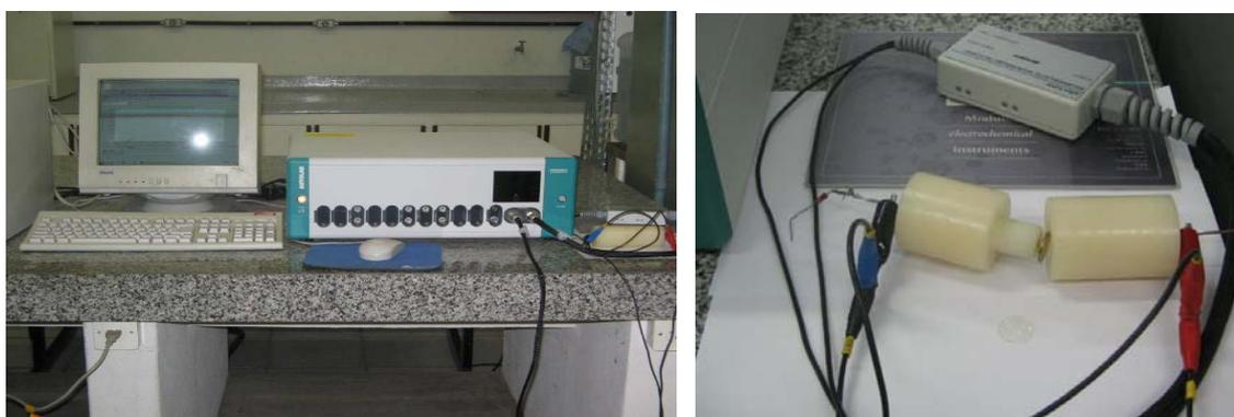
Figura 17 - AUTOLAB USB INTERFACE para Medida de EIS. Eletrodos Paralelos Usados para os Contatos Elétricos.
