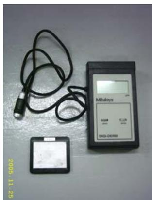
Figura 18 - Medidor Digital de Camadas Modelo Digi-Derm.
