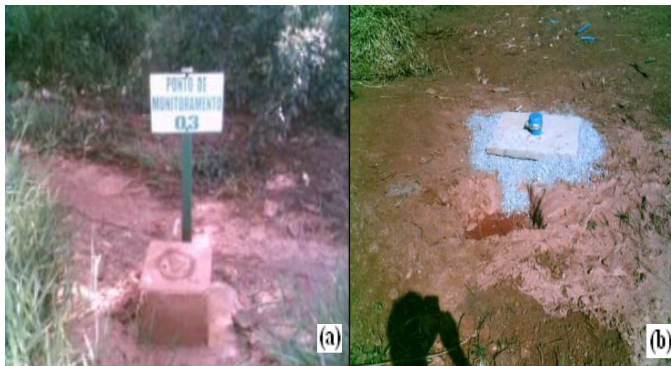
Figura 18: Poços de monitoramento instalados a jusante das áreas de Anápolis (a) e Aparecida de Goiânia (b)
