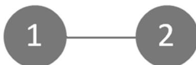
**FIGURA 3.20:** Cadeia com dois guias acoplados linearmente, **CA02**. A entrada do pulso é no guia 1.
