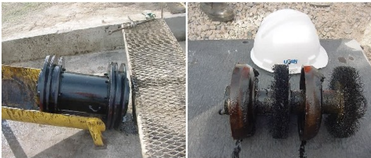
Figura 2.2 – Pigs de limpeza em tubulações de transporte de petróleo.
