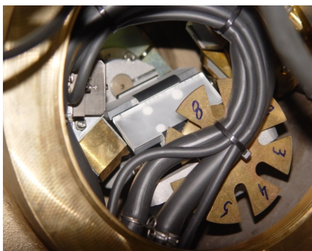
Figura 2.10 - Visão lateral do conjunto de cristais analisadores.
