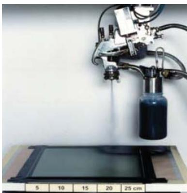
Fig.III.3 Deposição por “Spray” (automático).
