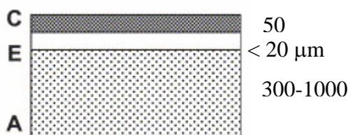
Fig.II.8 Célula suportada pelo anodo.
