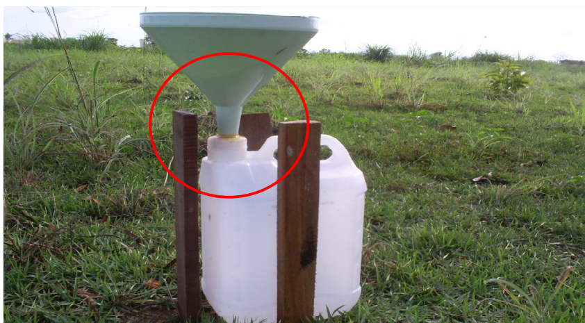
Figura 3: Coletor utilizado para medir a precipitação (P), sem influência do dossel.
