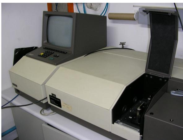
Figura 3.8 – Espectrofotômetro utilizado para ensaios de reflexão - espectro 290 a 1.800 nm.
