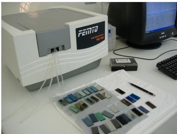
Figura 3.7 – Espectrofotômetro utilizado para ensaios de transmissão - espectro 1.100 a 1.800 nm.
