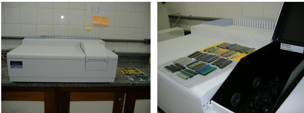
Figura 3.6 – Espectrofotômetro utilizado para ensaios de transmissão - espectro 290 a 1.100 nm.
