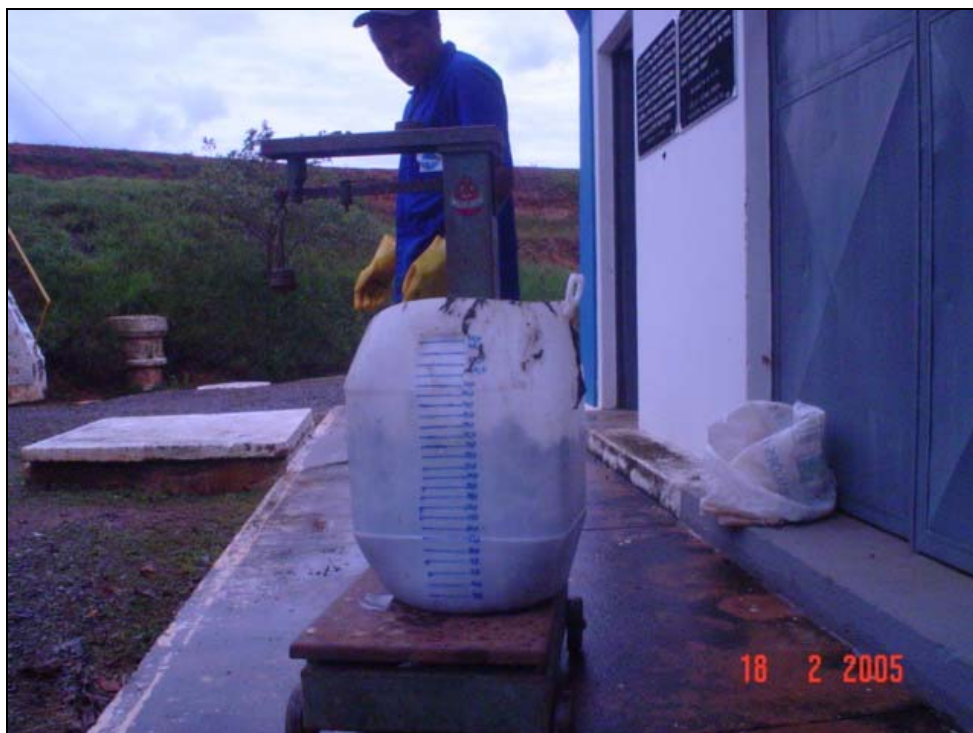
Fotografia 8 Vista do tambor e da balança utilizados na caracterização do material retido nas grades finas
