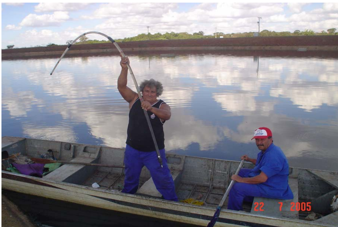
Fotografia 12 Vista da operação de medição de lodo com o sludge judge
