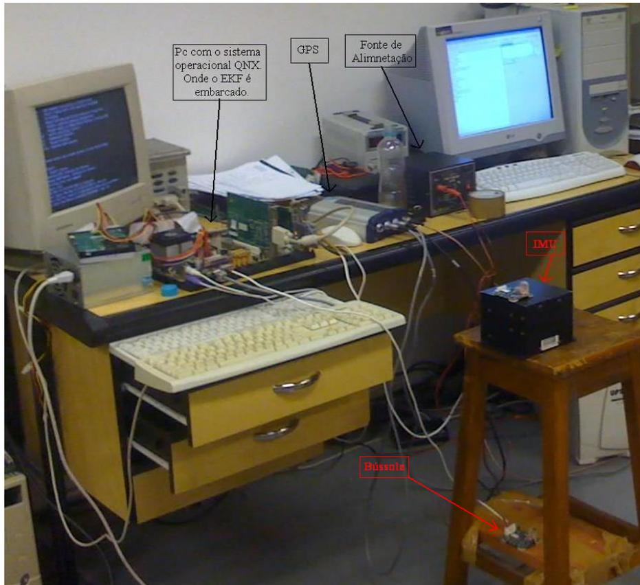
**Figura 8-1: Bancada de desenvolvimento e de testes estáticos.**
