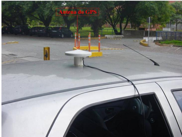
**Figura 8-3: Antena do GPS no veículo de teste.**
