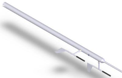
**Figura 3-8: ADB (ângulos de ataque e side-slip, temperatura, umidade e pressão atmosférica e velocidade do ar).**
