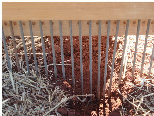
Figura 7. Perfilômetro utilizado para avaliar a área de solo mobilizado e a profundidade do corte do disco.
