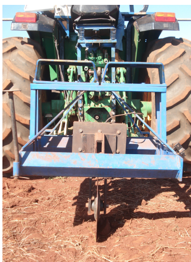
Figura 4. Vista do equipamento para ensaio de ferramentas rompedoras de solo.
