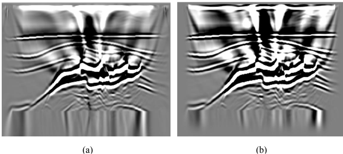
Figura 4.20 – Seção migrada com a condição de imagem: (a) *Correlação Cruzada Normalizada*, (b) *Condição prosposta em Bulcão 2004*, em outra escala de amplitudes.
