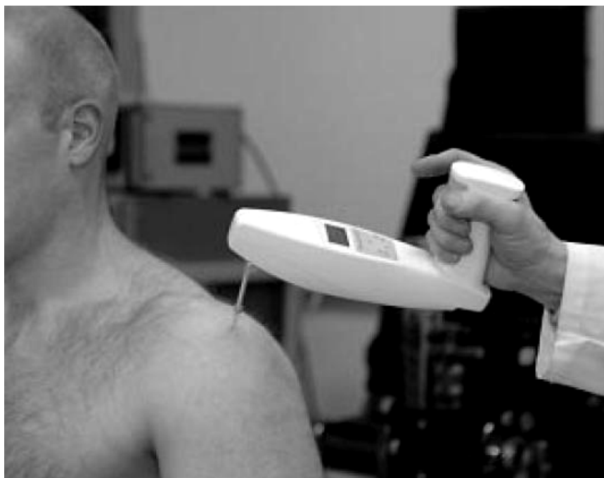
Figura 13 – Mensuração do tônus do músculo deltóide utilizando o Myoton (Extraído de http://www.myoton.ee/products.php ).
