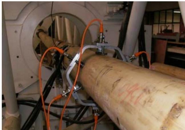
Figura V.11 – Montagem dos sensores indutivos no duto flexível.
