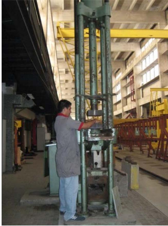
Figura IV.12 – Calibração das células de carga na prensa hidráulica.
