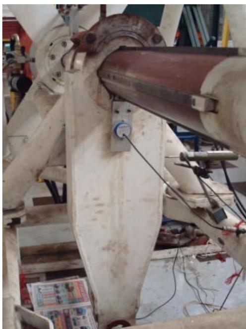
Figura V.9 – Inclinômetro "Inc 03" utilizado para medir a rotação do braço de torção.
