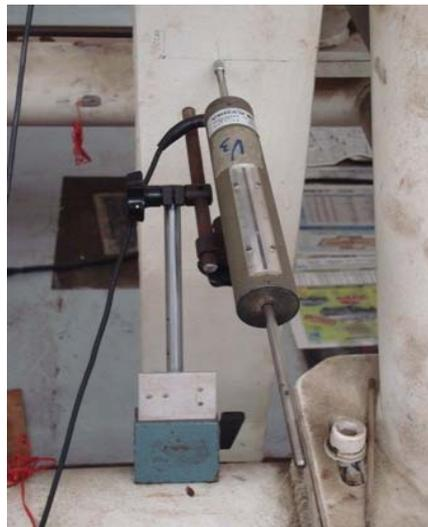
Figura V.4 – Flexímetro “*Flex 06*” utilizado para medir o avanço do eixo de torção da Máquina de Tração-Torção.
