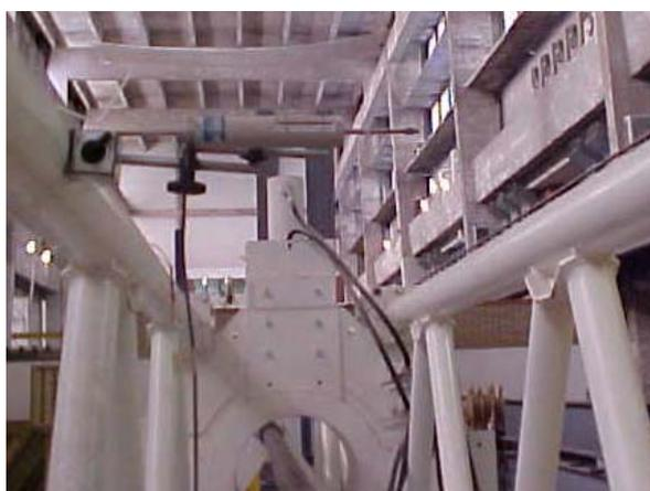
Figura IV.16 – Flexímetro “*Flex 03*” para medir a abertura transversal do equipamento.
