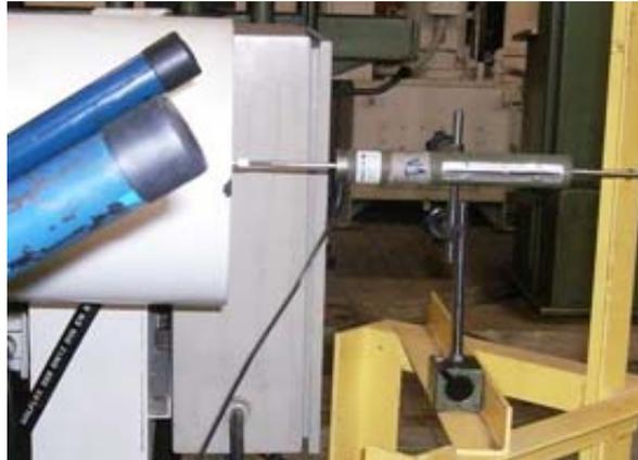
Figura IV.13 – Flexímetro “Flex 01” para medir o encurtamento na extremidade final do equipamento.
