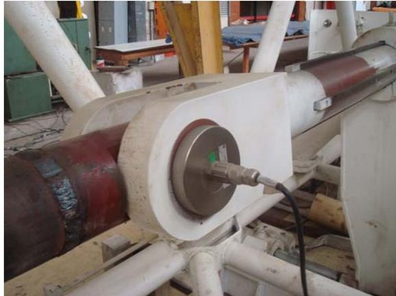
Figura IV.5 – “Load Cell 01” no eixo de tração com capacidade de 1000kN na Máquina de Tração-Torção.
