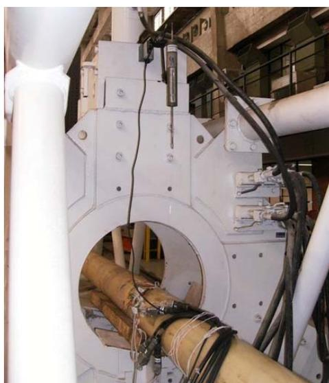
Figura V.6 – Flexímetro “Flex 07” utilizado para medir a flecha do duto com o aumento da carga.
