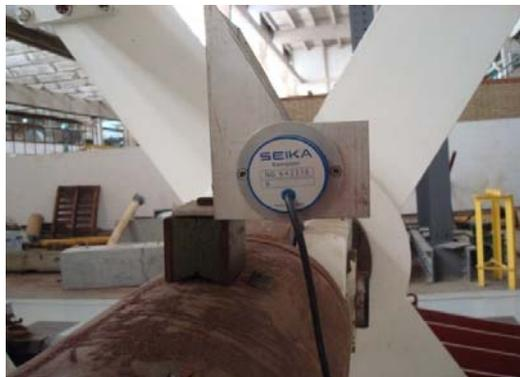
Figura V.8 – Inclinômetro “*Inc 02*” utilizado para medir a rotação do duto no extremo inicial.
