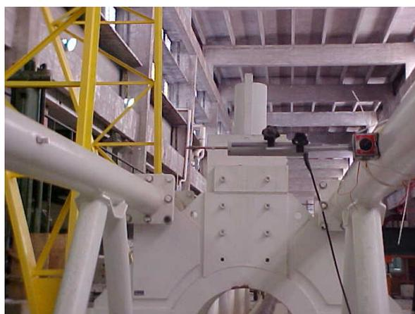
Figura IV.17 – Flexímetro “*Flex 04*” para medir a abertura transversal do equipamento.
