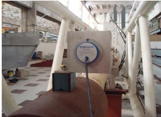
Figura V.7 – Inclinômetro “*Inc 01*” utilizado para medir a rotação do duto no extremo final.
