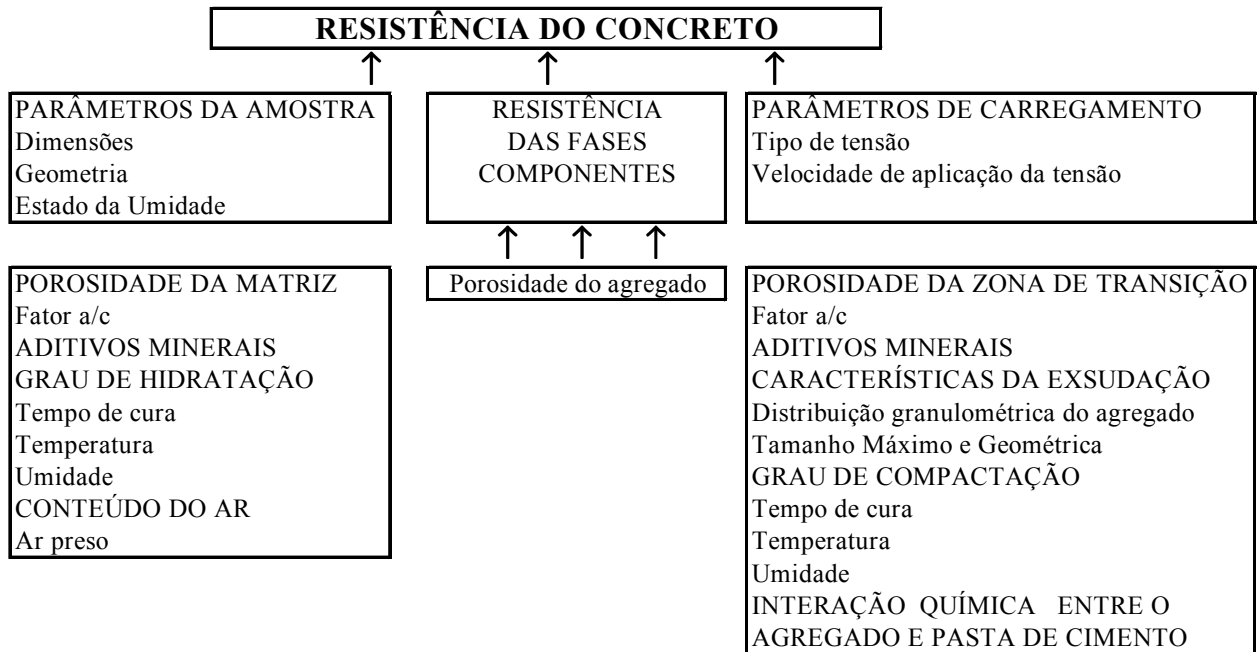
Ilustração 17 – Fatores que influenciam a resistência do concreto (MEHTA; MONTEIRO, 1994).
