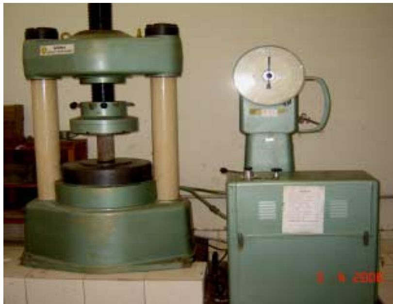
Ilustração 38 – Prensa hidráulica da WPM, modelo DIMB-200.
