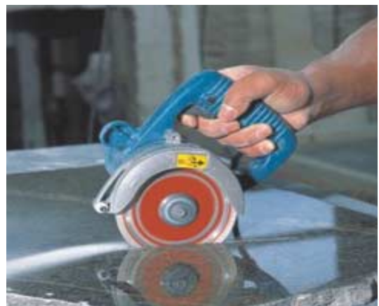
Ilustração 6b – Corte das chapas com a serra circular, sem a utilização de água.
