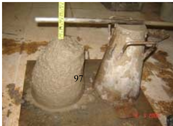
Ilustração 39 - Ensaio de Abatimento do tronco de cone.
