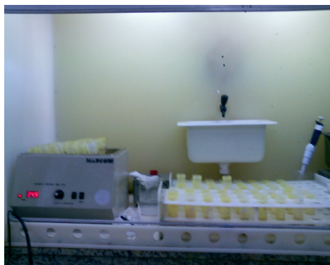
Figura 5 – Processo de digestão do tecido vegetal para posterior determinação do teor de Silício.
