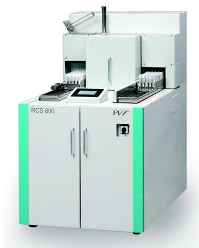
**Figura 12:** Máquina de uso laboratorial automatizada para tampagem de tubos.
