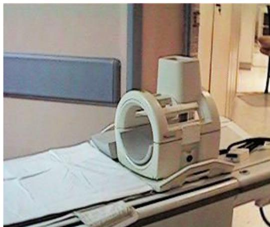
**Figura 8:** Bobina de quadratura do joelho
