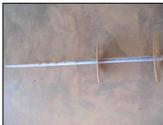
Figura 4.6 – Fotografia do medidor de espuma.
