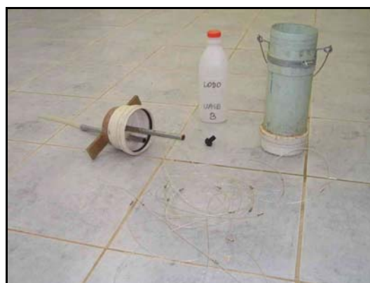
Figura 4.4 – Fotografia do amostrador de manta de lodos.
