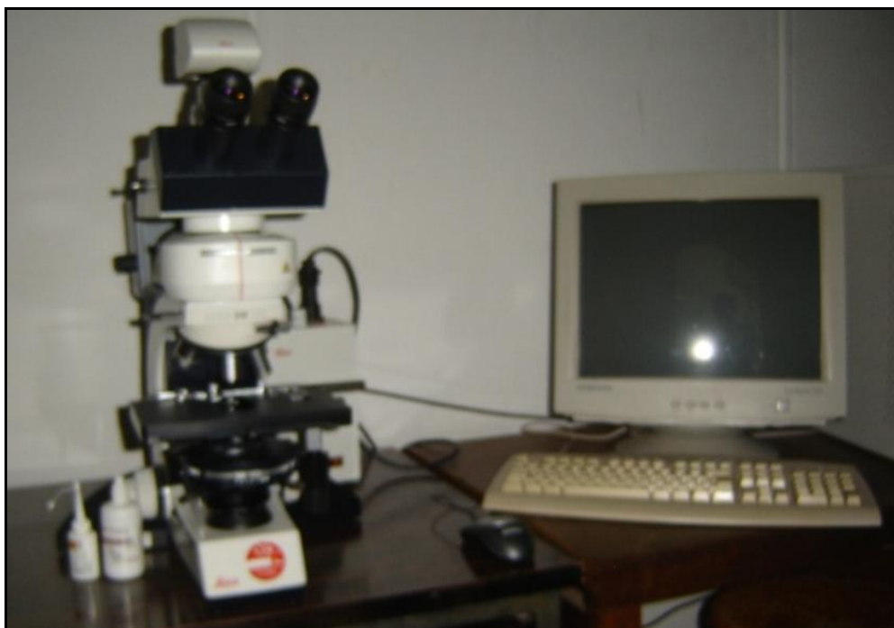
Figura 4.2 – Sistema de aquisição de imagens para realização de microscopia das morfologias presentes no lodo anaeróbico do reator UASB.
