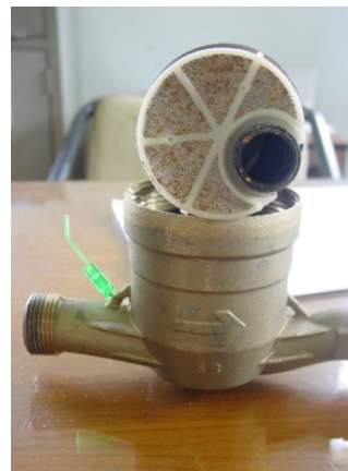
Figura 3.22 – (a) Filtro de retenção para prevenção de obstrução no hidrômetro; (b) Obstrução provocada por areia no filtro de um medidor do tipo volumétrico
