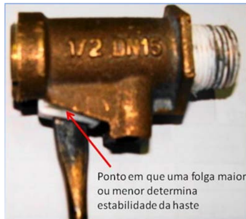
Figura 5.3 – Detalhe da cabeça da bóia 1 – folga no mecanismo de encaixe da haste
