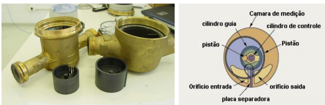
Figura 3.10 – (a) Hidrômetro volumétrico - câmara e pistão oscilante; (b) Características do hidrômetro de pistão oscilante (Frangipani, 2005)
