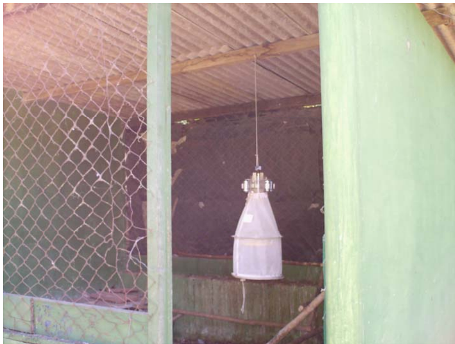
Figura 5. Armadilha luminosa tipo CDC adaptado, colocada em galinheiro de alvenaria. Bairro Graminha, Engenheiro Paulo de Frontin, Rio de Janeiro, Brasil, 2007.
