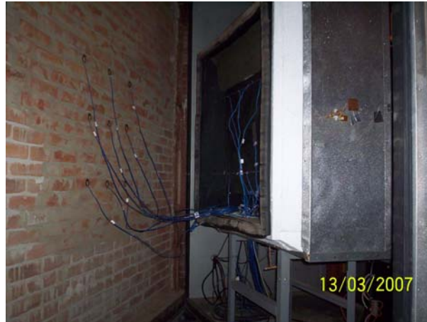
Figura 3.23 Fixação dos termopares.
