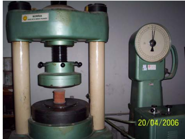
Figura 3.10 Corpo-de-prova cilíndrico sob compressão.
