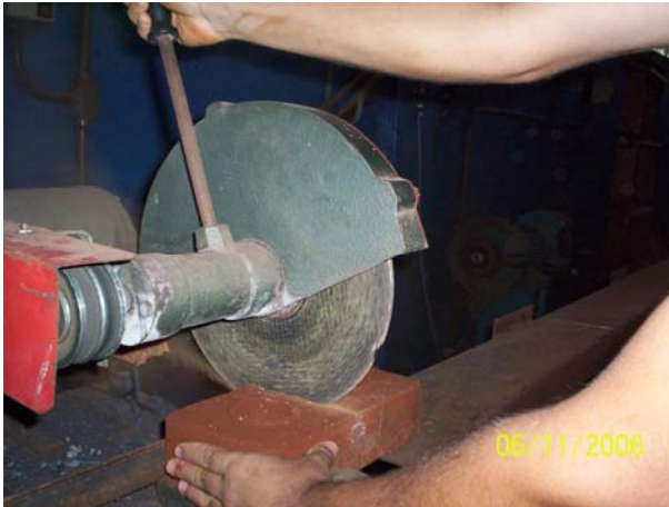
Figura 3.17 Tijolo sendo serrado ao meio.
