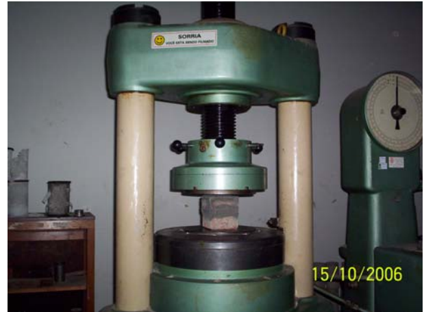
Figura 3.18 Tijolo sob compressão.
