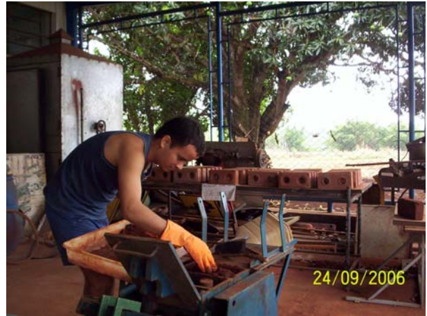
Figura 3.14 Colocação da mistura solo-cimento-resíduo na fôrma.
