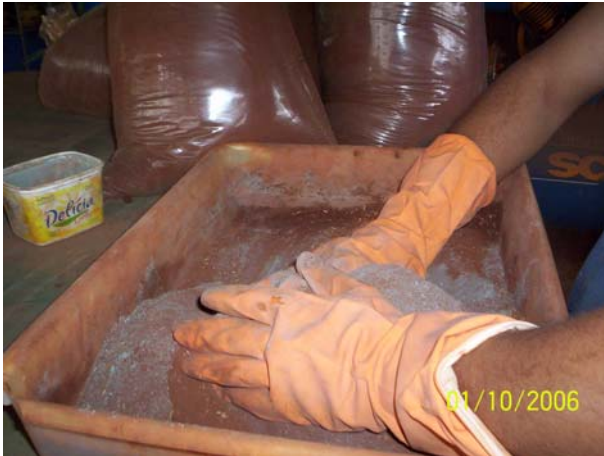
Figura 3.13 Mistura manual do solo-cimento-resíduo.
