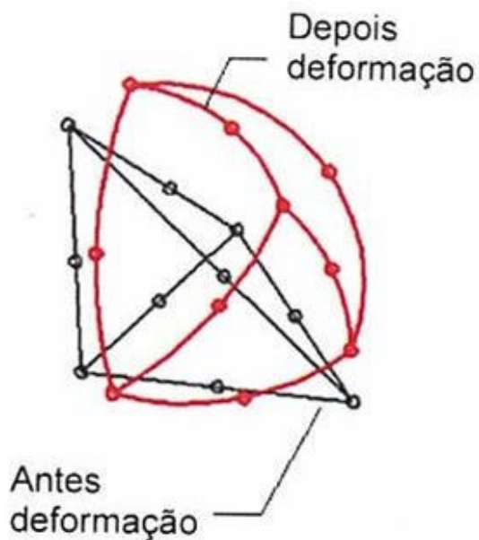
FIGURA B.1 – Elemento tetraédrico de segunda ordem
