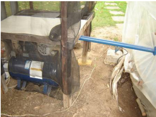
Figura 4.9: Fotografia do compressor conectado a câmara.
