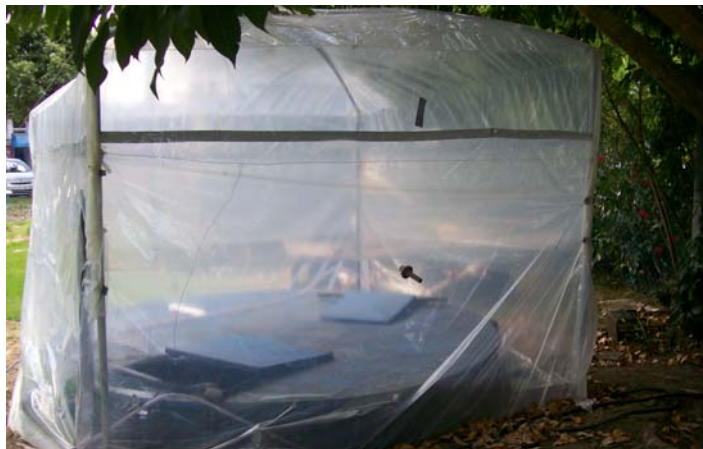
Figura 4.3: Câmara de fluxo construída sobre a elevatória.
