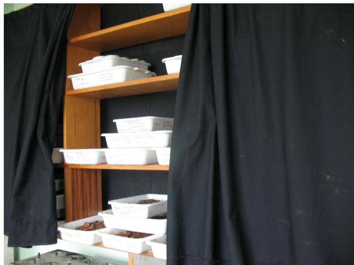
Figura 3.11. Acondicionamento das amostras submetidas ao ensaio em solo simulado.
