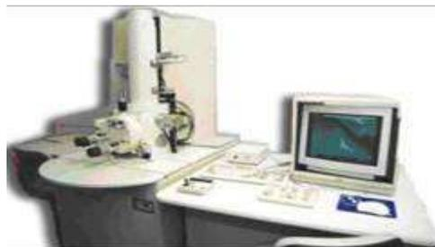
Figura 3.7. Microscópio eletrônico de varredura.
