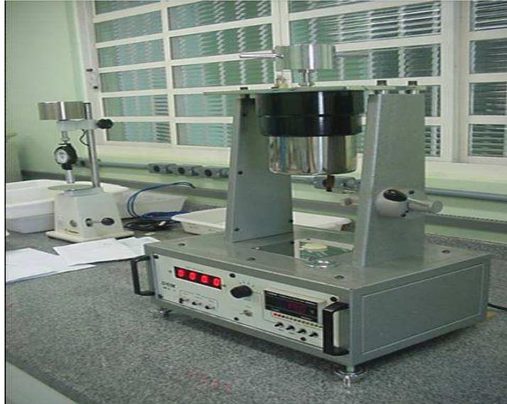
Figura 3.5. Plastômetro utilizado na determinação do índice de fluidez.
