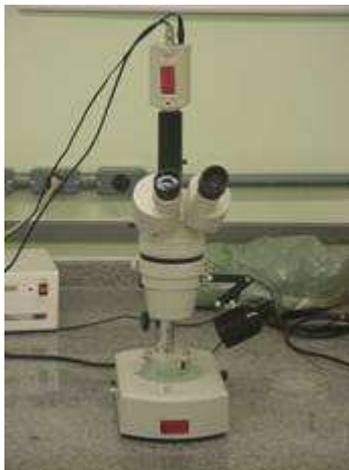
Figura 3.8. Microscópio óptico.
