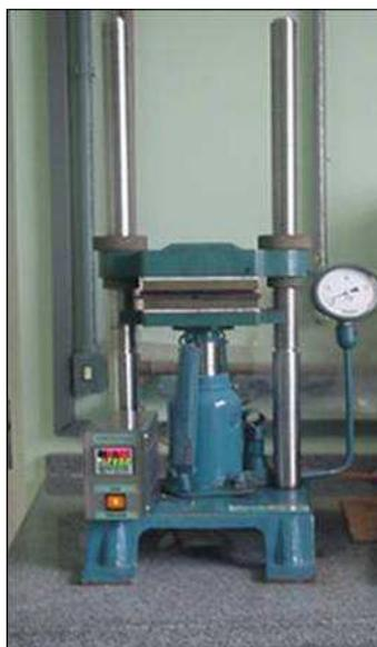
Figura 3.3. Prensa hidráulica utilizada na preparação dos filmes.
