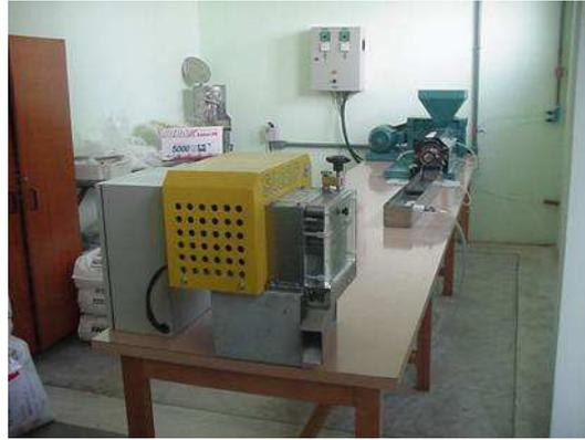
Figura 3.2. Extrusora utilizada na preparação das blendas.
