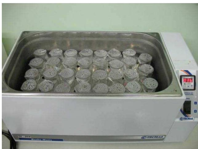
Figura 3.9. Banho-maria utilizado no ensaio de degradação enzimática
