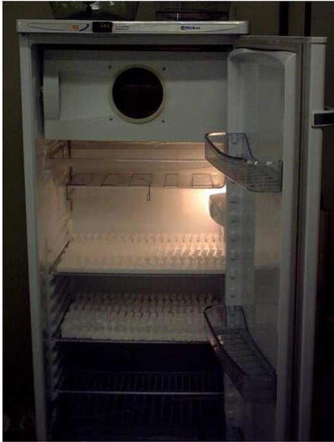
Figura 3.4. Estufa tipo BOD utilizada no envelhecimento térmico
