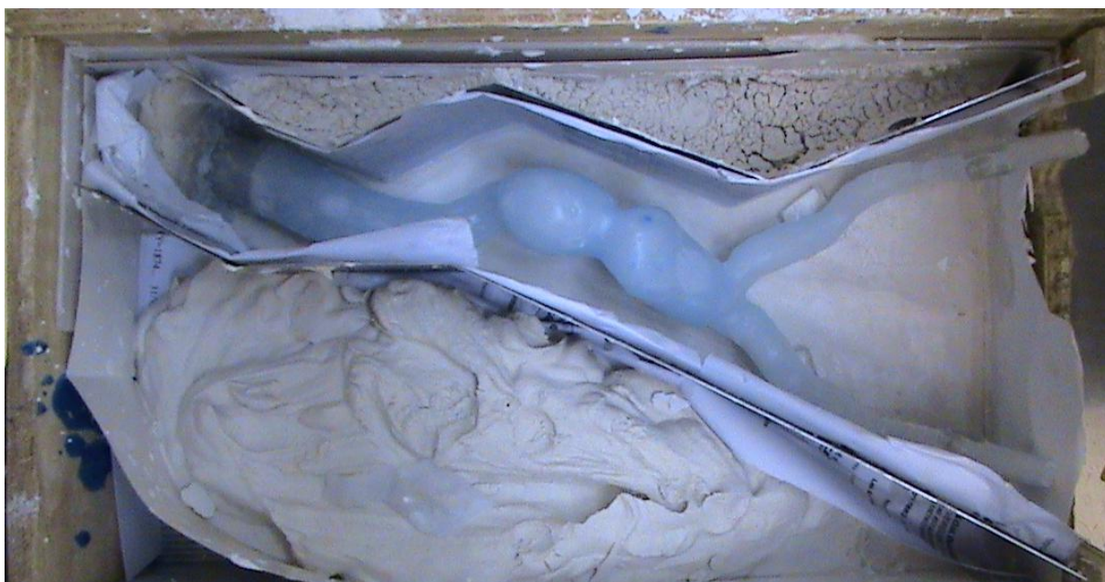
Figura 12 Recipiente com o modelo de AAA em parafina para confecção da peça em resina.
