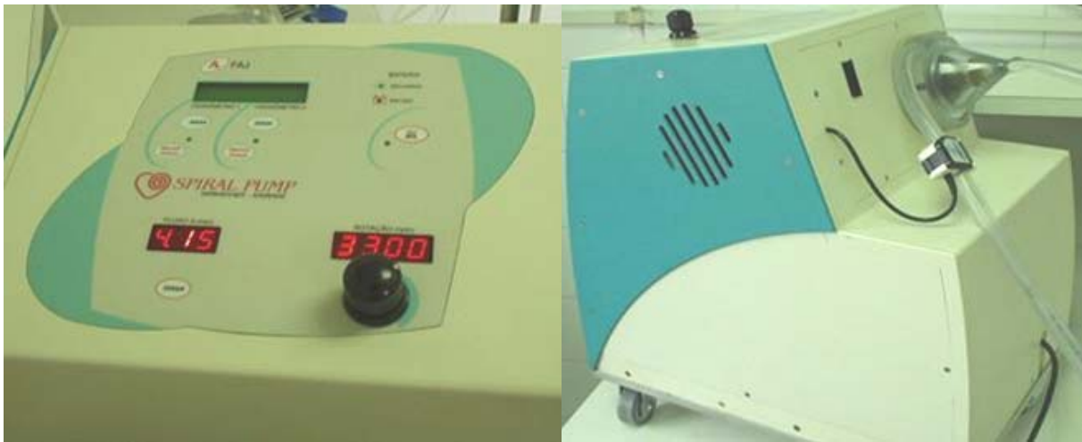
Figura 27 Bomba de fluxo contínuo utilizada no levantamento da curva de calibração.
