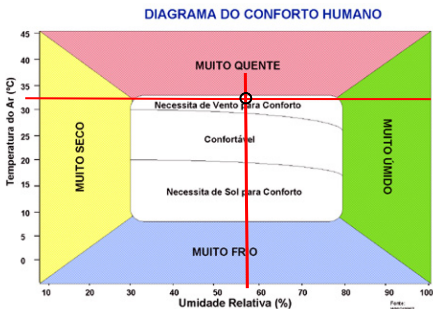
Gráfico 2: diagrama para a definição do conforto humano em Vitória com relação à temperatura e a umidade relativa do ar.
