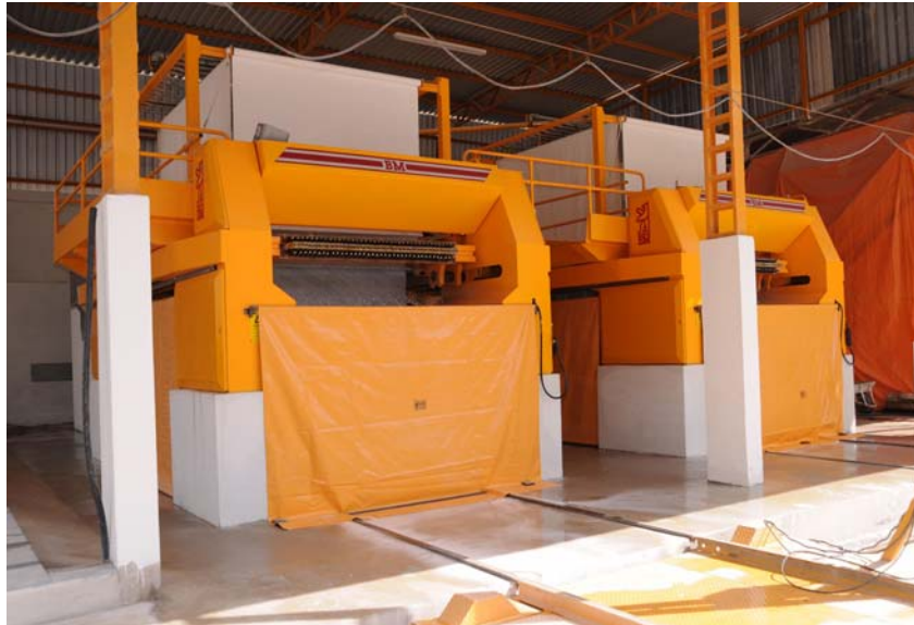
Figura 4 - Tear com sistemas de corte diamantado composto por conjunto de lâminas de aço com pastilhas de diamante industrial e arrefecido simplesmente com água (Cachoeiro de Itapemirim, ES – foto do autor).
