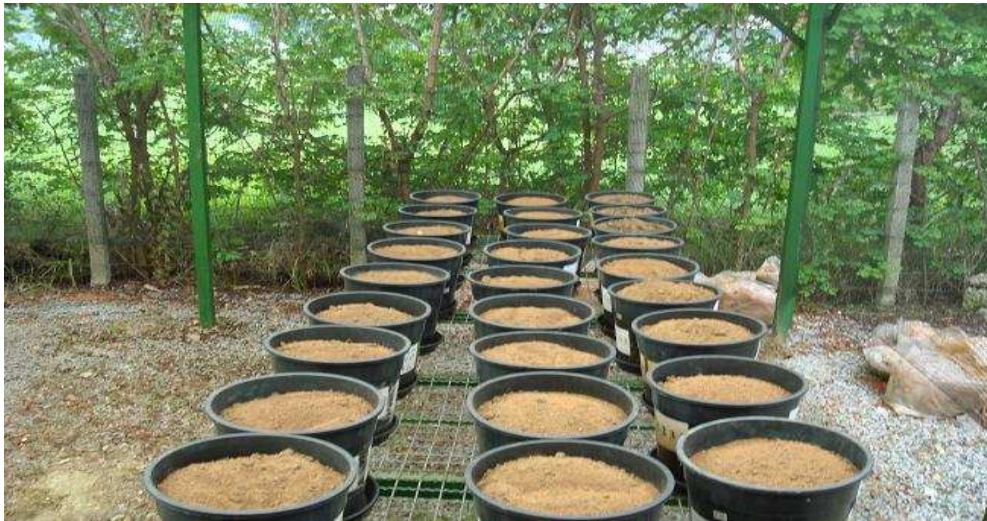
Figura 3.25 Sistema solo- contaminante entrando em equilíbrio durante 15 dias, antes de iniciar o plantio
