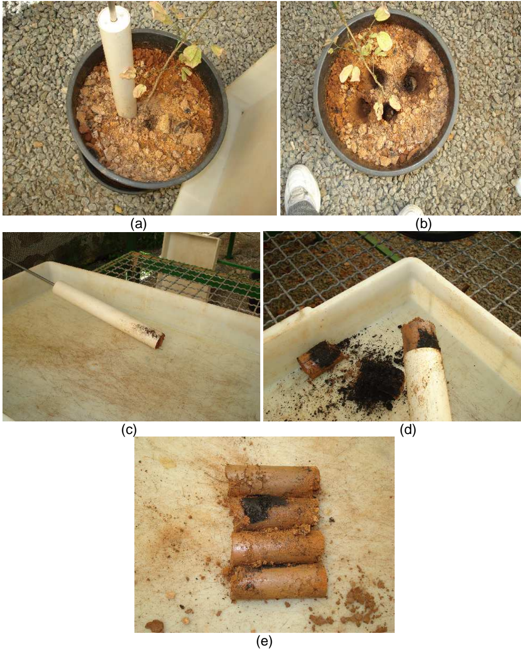
Figura 3.7: Coleta de solo utilizando o amostrador: (a) início da amostragem, (b) os quatro pontos coletados, (c) e (d) retirada dos solos coletados e (e) as quatro amostras antes de serem quarteadas
