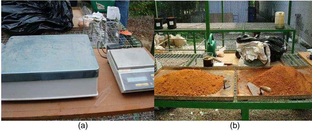
Figura 3.24: (a) balanças para pesar o contaminante (LCO) e o solo; (b) bandejas para homogeneização solo/óleo.
