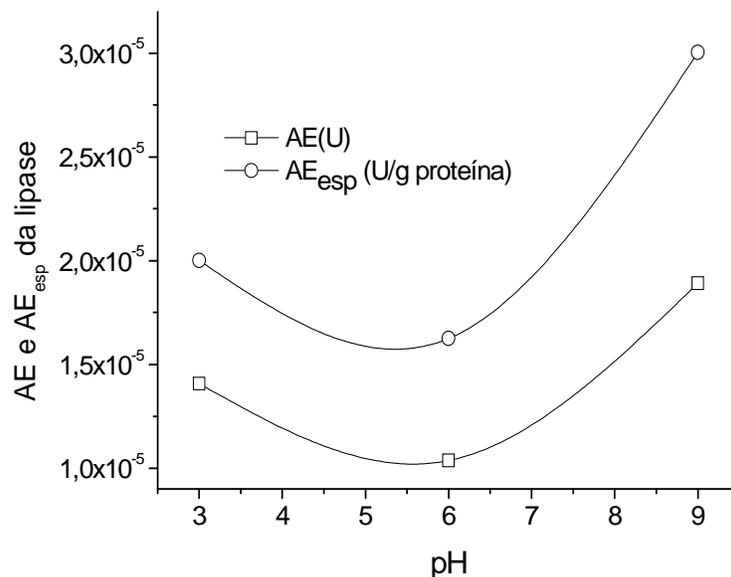
**Figura 4.20.** Perfis de AE e AE<sub>esp</sub> para a lipase em função do pH
