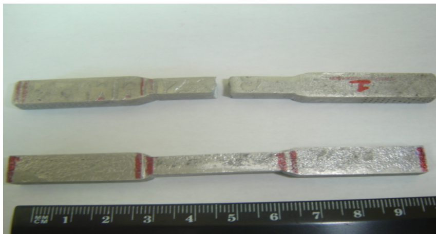
Figura 3.11. Corpos de prova para o ensaio de tração antes e depois do ensaio (ESP1).
