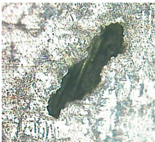
Figura 3.4. Detalhe de uma imperfeição na estrutura do ESP1 (aumento de 10 x).
