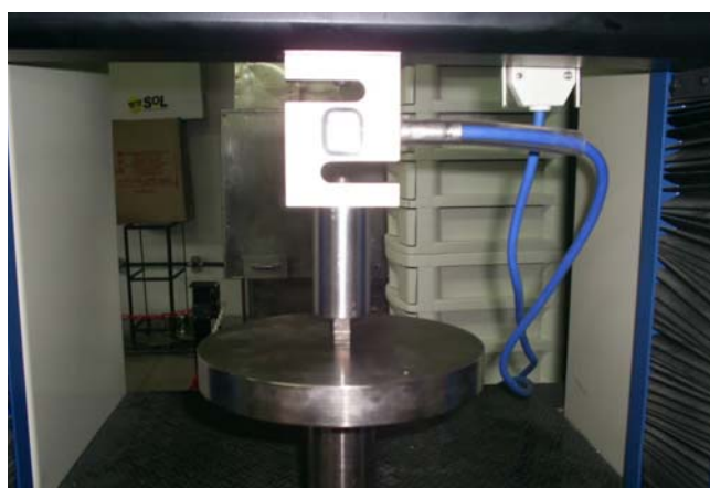
Figura 3.13: Ensaio de compressão de um corpo de prova de material elastomérico.
