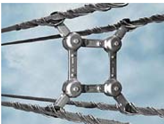
Figura 1.1. Exemplo da montagem do espaçador amortecedor na linha de transmissão (Fonte: Site PLP).
