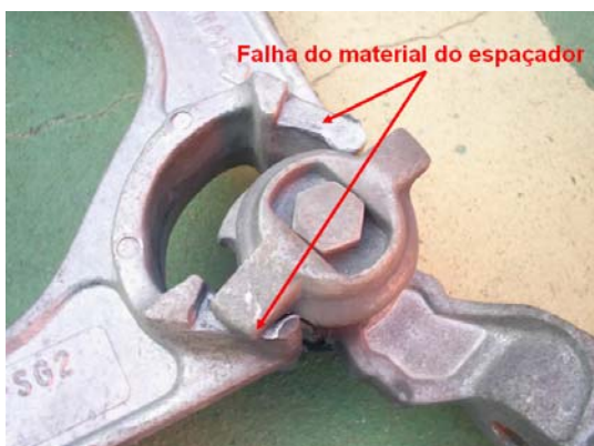
Figura 1.2. Falha do material do espaçador amortecedor devido à ação do vento.
