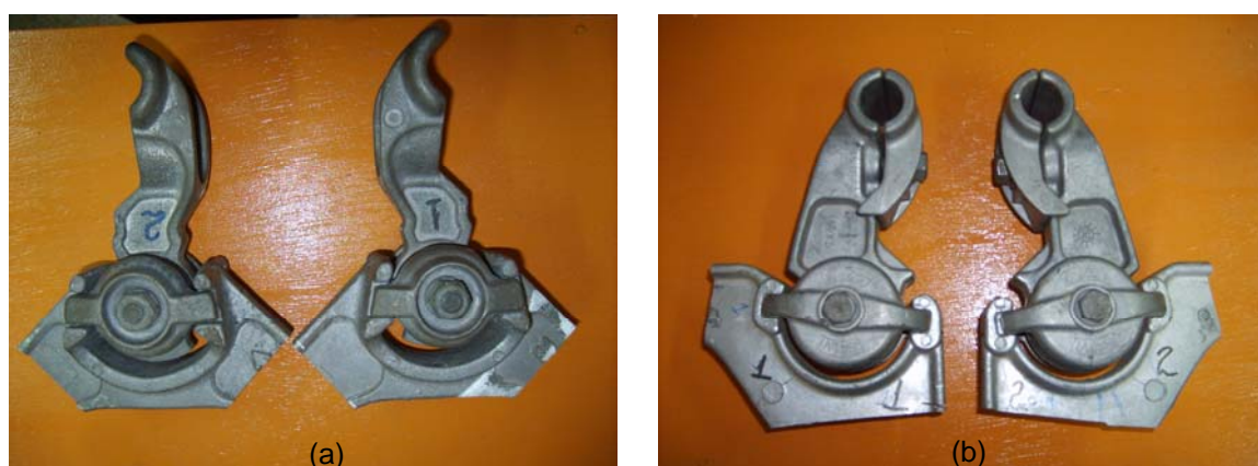
Figura 7.1. Corpos de prova utilizados na análise dos espaçadores (a) ESP1 e (b) ESP2.
