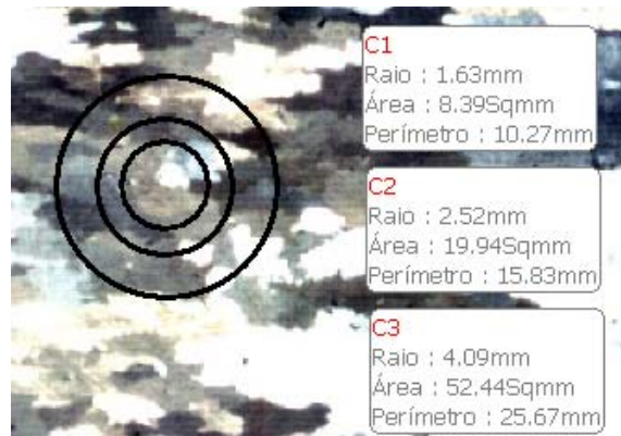
Figura 3.14. Método da intersecção (dos três círculos) para determinação do tamanho de grão - Software MOTIC.
