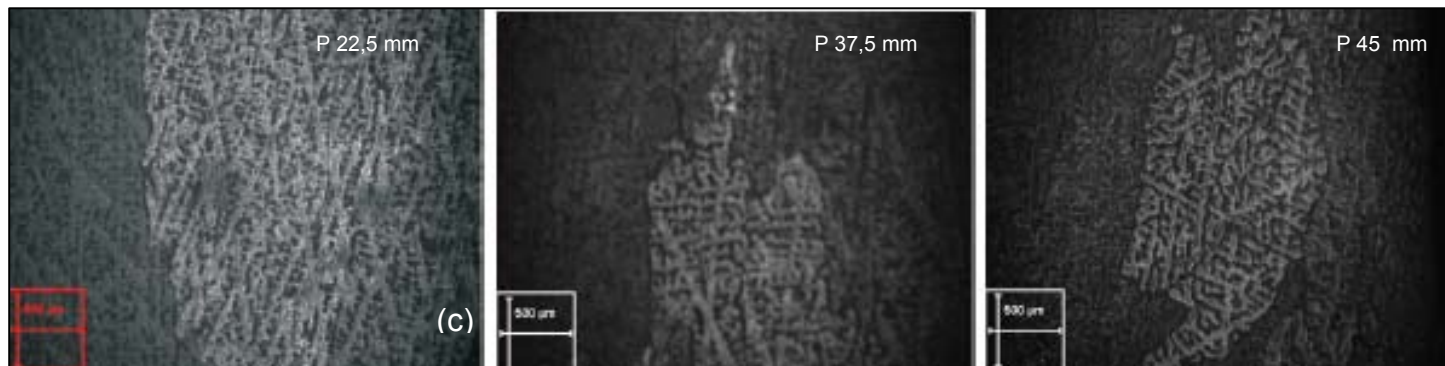
Figura 4. 18. a) EDS em função da posição (P) das ligas LA45 e LA 43; b) microestrutura obtida para a liga LA45 (50x); c) microestrutura obtida para a liga LA43 (50x).
