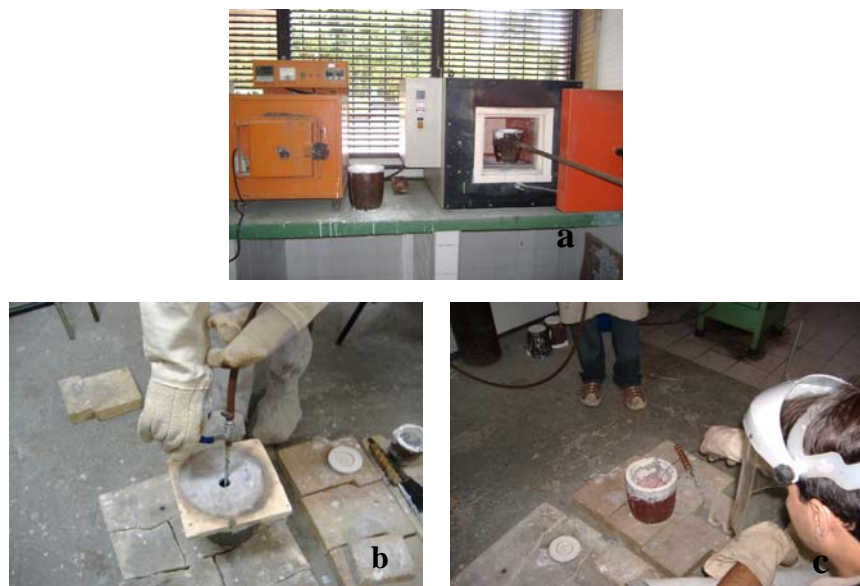
Figura 3.6. a) Retirada do cadinho do forno; b) injeção do gás argônio no cadinho; c) introdução do termopar no metal líquido.
