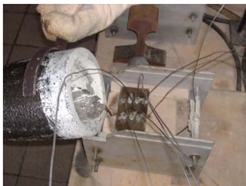
Figura 3.7. Vazamento da liga e posicionamento dos termopares (7,5mm; 15,0mm; 22,5mm; 30,0mm; 37,5mm e 45,0mm) na câmara.
