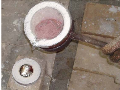
Figura 3.8. Vazamento da amostra testemunho.
