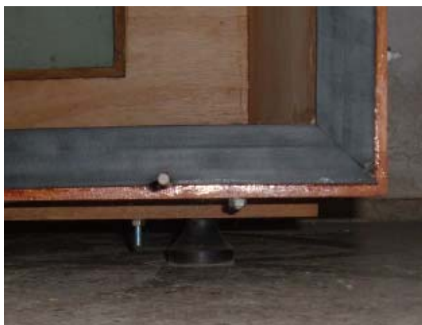
Figura 4.7 – Câmara com os isoladores de vibração instalados.
