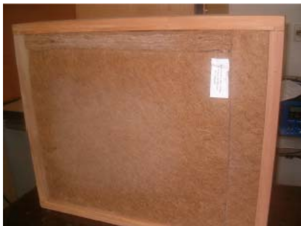
Figura 4.11 – Instalação da fibra de coco.
