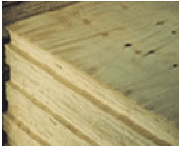
Figura 4.12 – Fibras das camadas de compensado.
