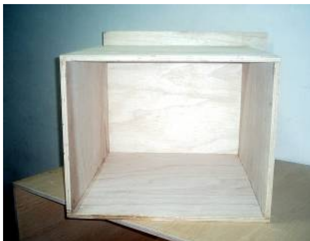
Figura 4.3 – Câmara Emissora em fase de montagem.
