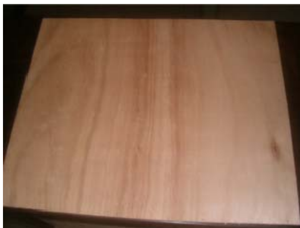
Figura 4.18 – Chapa de Compensado de 4 mm.
