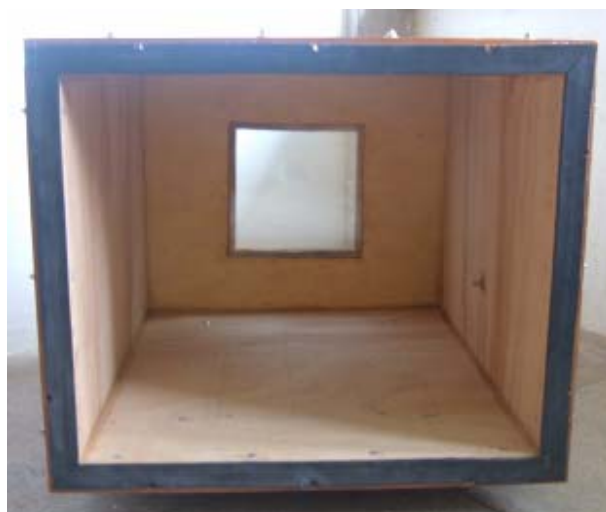
Figura 4.6 – Câmara com a borracha instalada.
