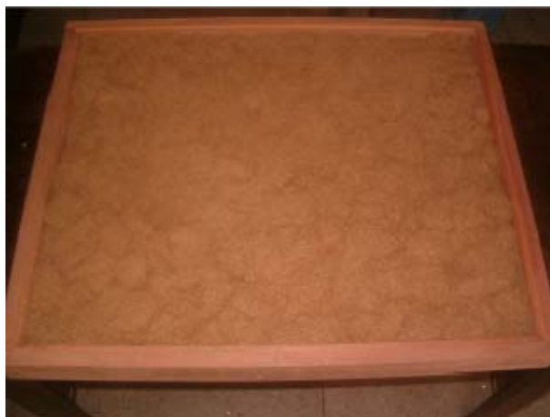
Figura 4.17 – Manta de Fibra de açai.
