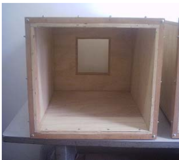
Figura 4.4 – Câmara com a instalação das tiras de madeira.
