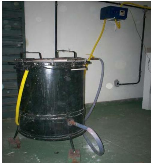
Figura 3.5 - Dispositivo de solidificação unidirecional vertical ascendente (RIBEIRO, 2007).
