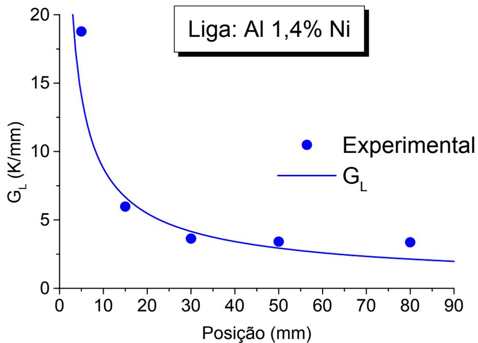
Figura 4.8 - Gráfico do gradiente de temperatura em função da posição dos termopares na liga Al -1,4%Ni.
