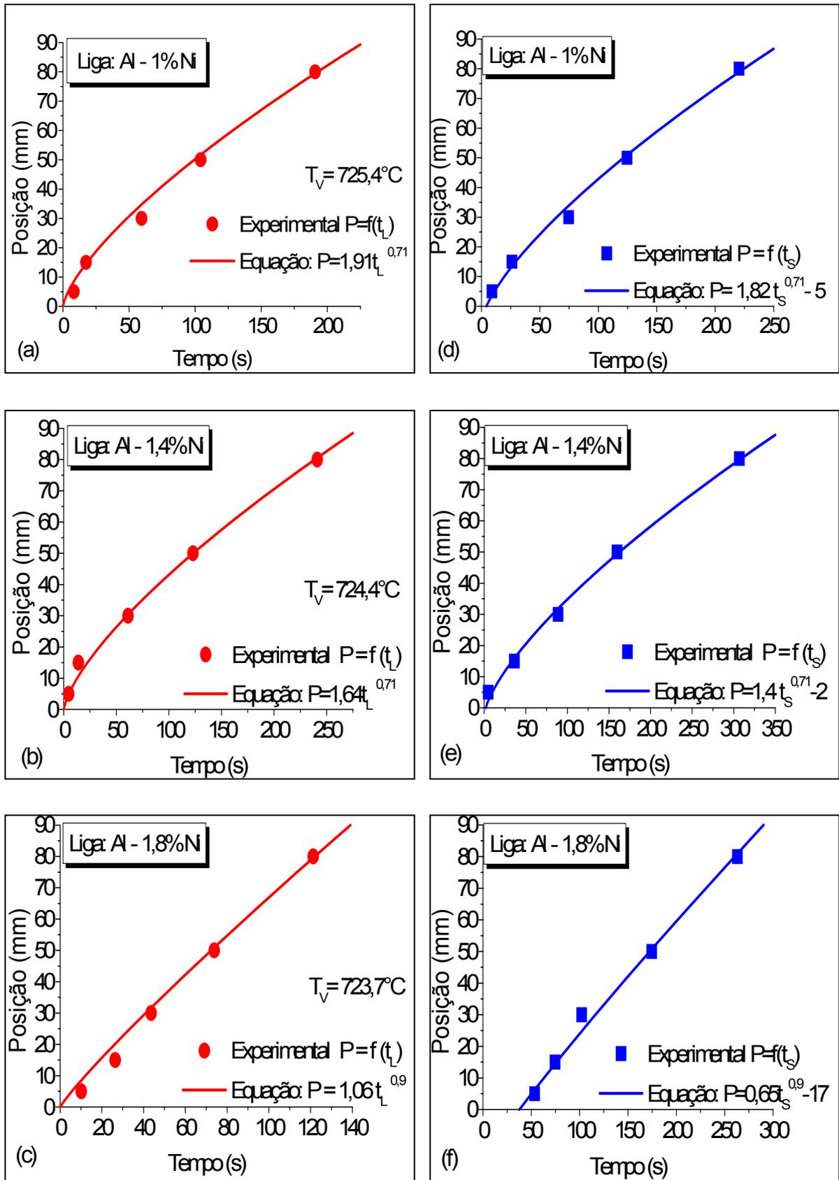
Figura 4.3 - (a), (b) e (c) Tempo de passagem das isothermas liquidus e (d), (e) e (f) das isothermas solidus em função da posição para as ligas Al-1%Ni, Al-1,4%Ni e Al-1,8%Ni respectivamente.
