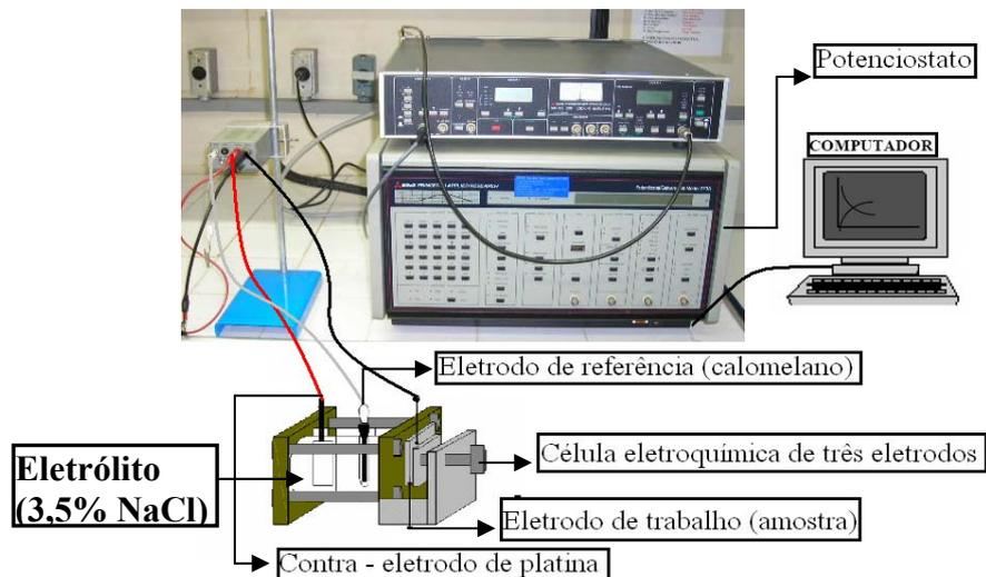
Figura 3.15 - Ilustração esquemática para os ensaios de polarização potenciodinâmica e polarização potenciodinâmica cíclica.
