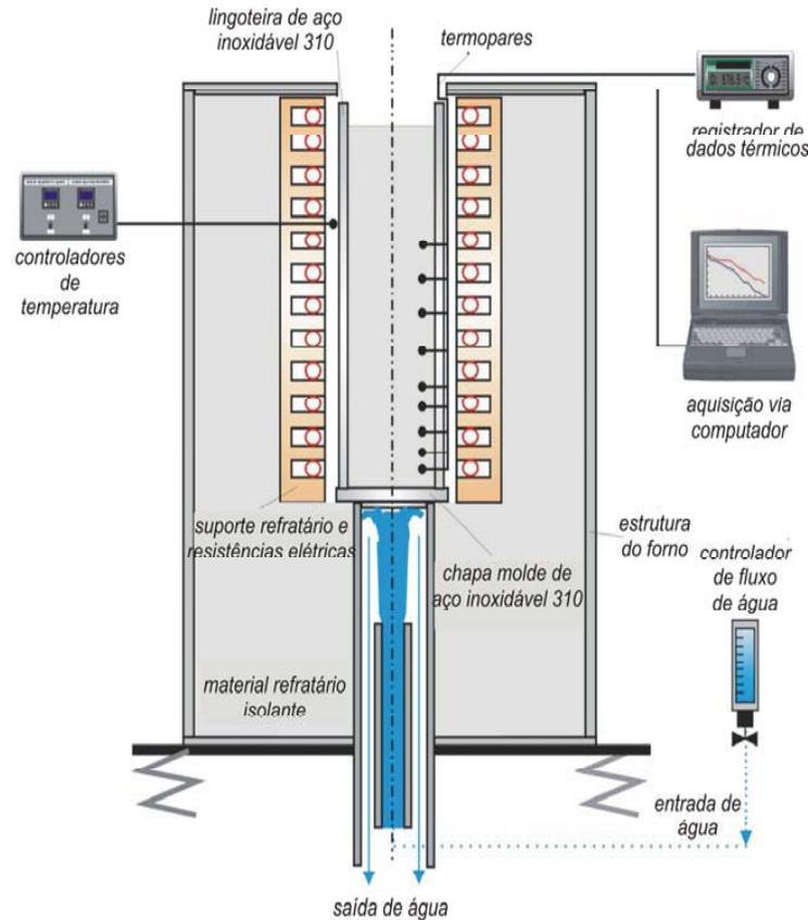
Figura 2.3 - Dispositivo de solidificação unidirecional vertical ascendente (GOULART, 2005).
