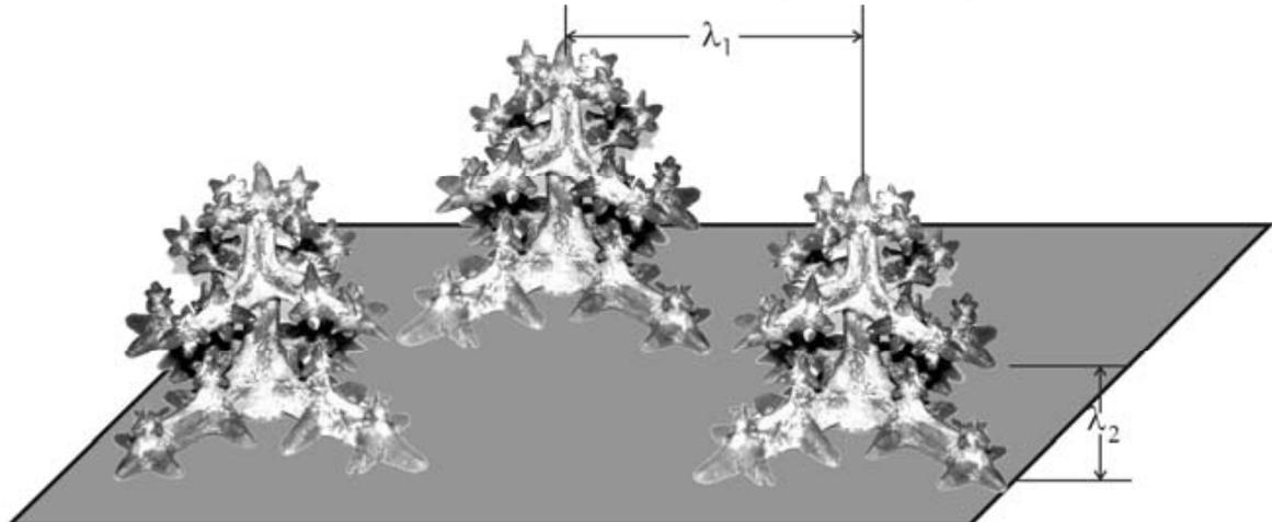
Figura 2.5 - Esquema representativo das ramificações interdendríticas primárias ( $\lambda_1$ ) e secundárias ( $\lambda_2$ ) (GOULART, 2005).
