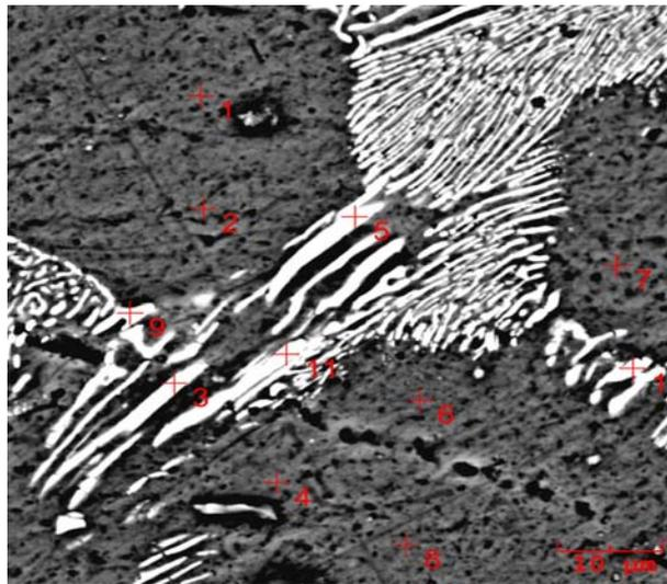
Figura 4.23 - Micrografia da liga Al-1,8%Ni obtidas por MEV com técnica de elétrons retroespalhados, evidenciando o rejeito de Ni (regiões brancas) nos contornos (aumento de 5000 vezes).
