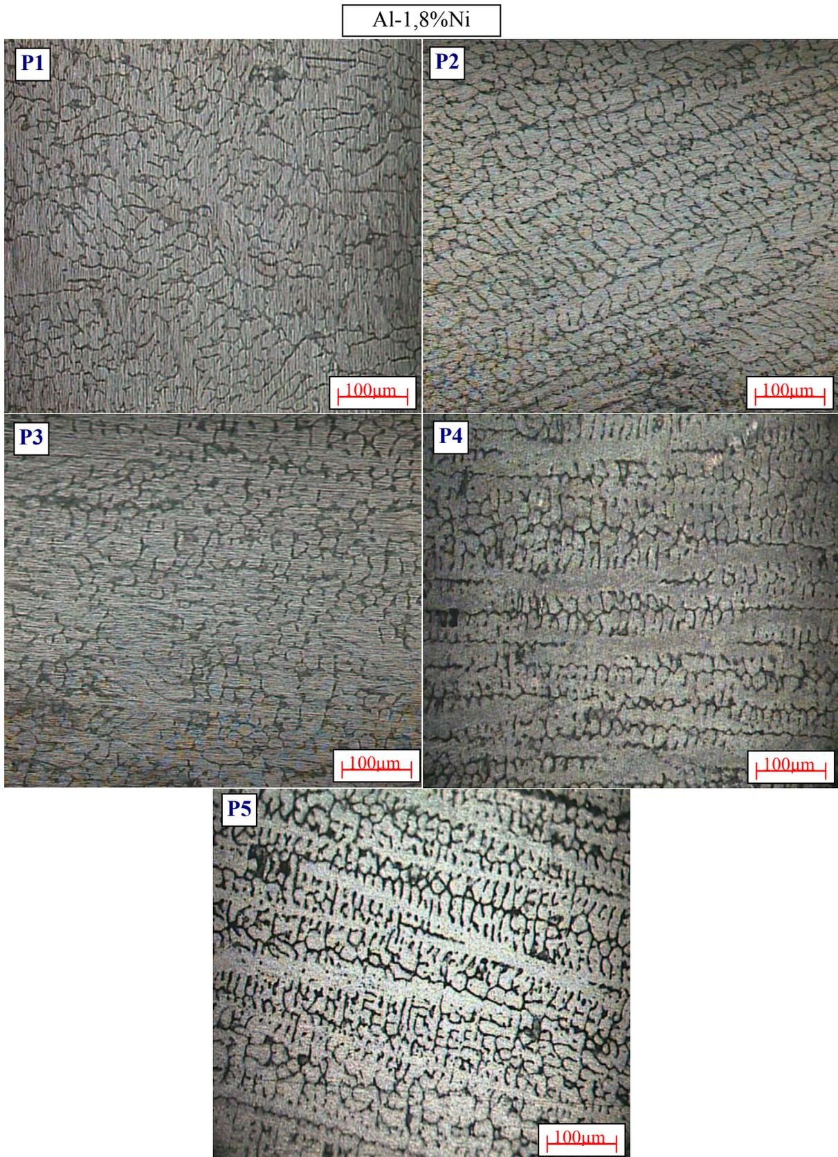
Figura 4.13 - Micrografias da Liga Al-1,8%Ni e respectivas posições relativas, com o mesmo aumento óptico (100 vezes), evidenciando o refino do espaçamento dendrítico secundário (barra de medida com 100µm).
