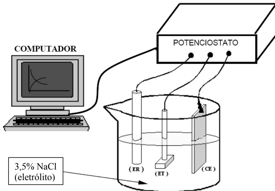
Figura 2.10 - Arranjo esquemático para levantamento de curvas de polarização, onde ER é o eletrodo de referência, ET é o eletrodo de trabalho (amostra) e CE é o contra-eleto (Platina), mergulhados em solução de 3,5% NaCl (SANTOS, 2005).
