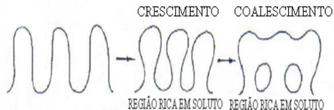
Figura 2.8 - Esquema ilustrativo da formação das regiões ricas em soluto no fenômeno do coalescimento dos ramos dendríticos secundários (FLEMINGS, 1974; GARCIA, 2001).
