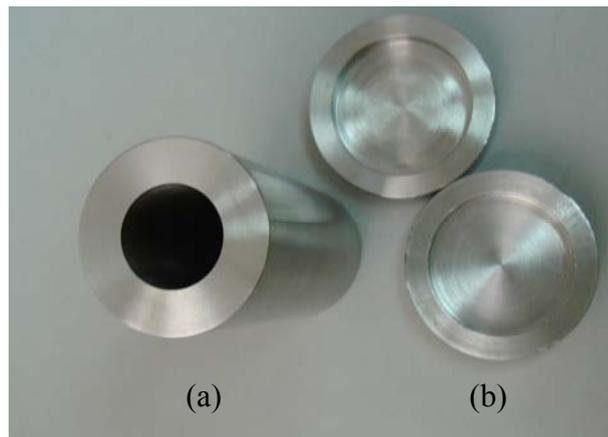
Figura 3.4 - (a) Lingoteira de aço inoxidável (Molde Lateral) e (b) chapa molde de aço carbono (Molde Inferior) utilizada na solidificação ascendente e obtenção dos lingotes resultantes.
