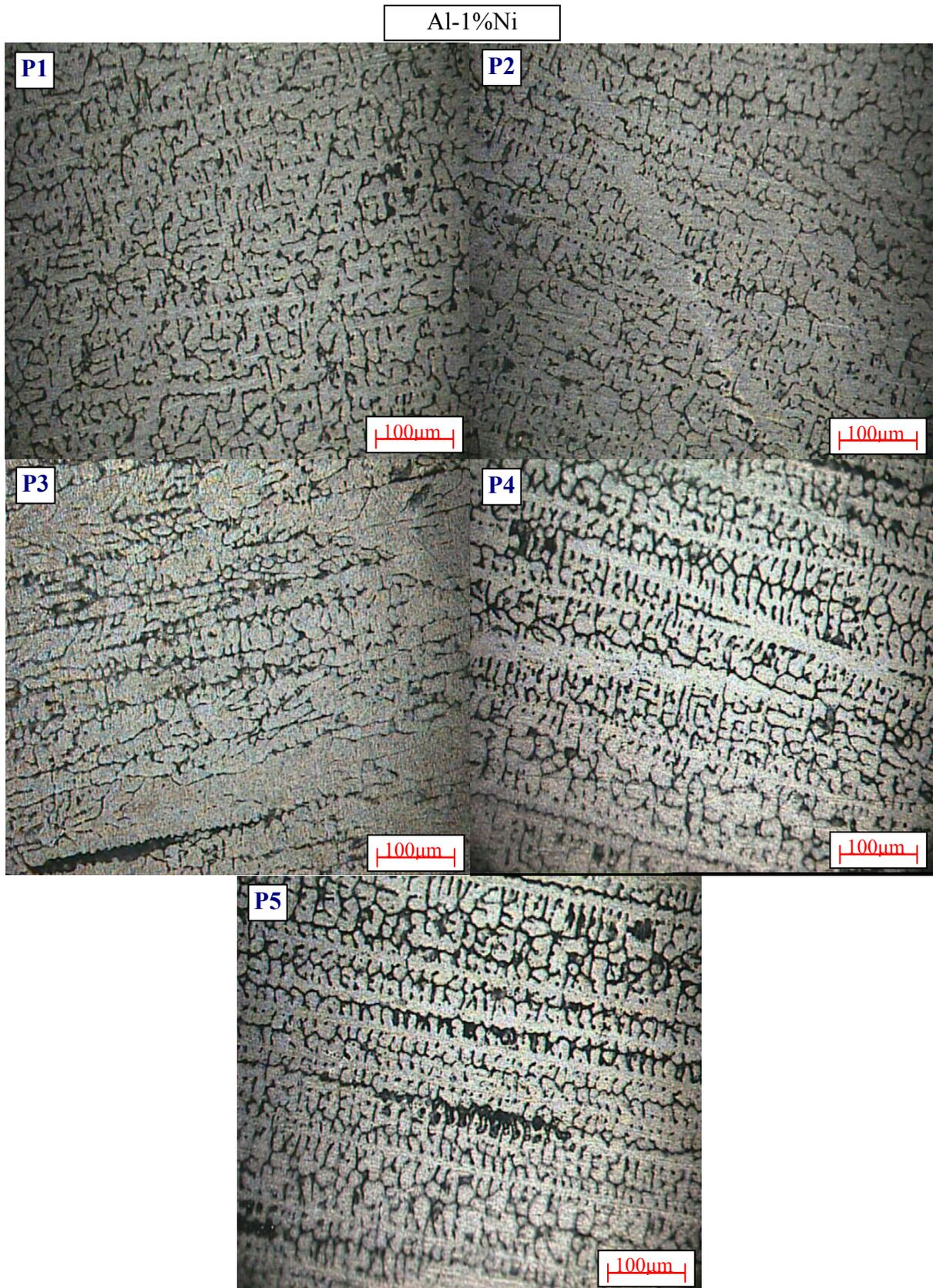
Figura 4.11 - Micrografias da Liga Al-1%Ni e respectivas posições relativas, com o mesmo aumento óptico (100 vezes), evidenciando o refino do espaçamento dendrítico secundário (barra de medida com 100µm).
