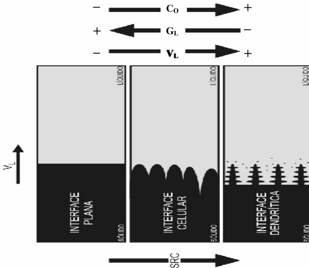
Figura 2.4 - Representações esquemáticas da atuação dos fatores de influência na formação das estruturas de solidificação: SRC – grau de super-resfriamento;  $G_L$  – gradiente térmico à frente da interface;  $V_L$  – velocidade da interface; e  $C_o$  – concentração de soluto.
