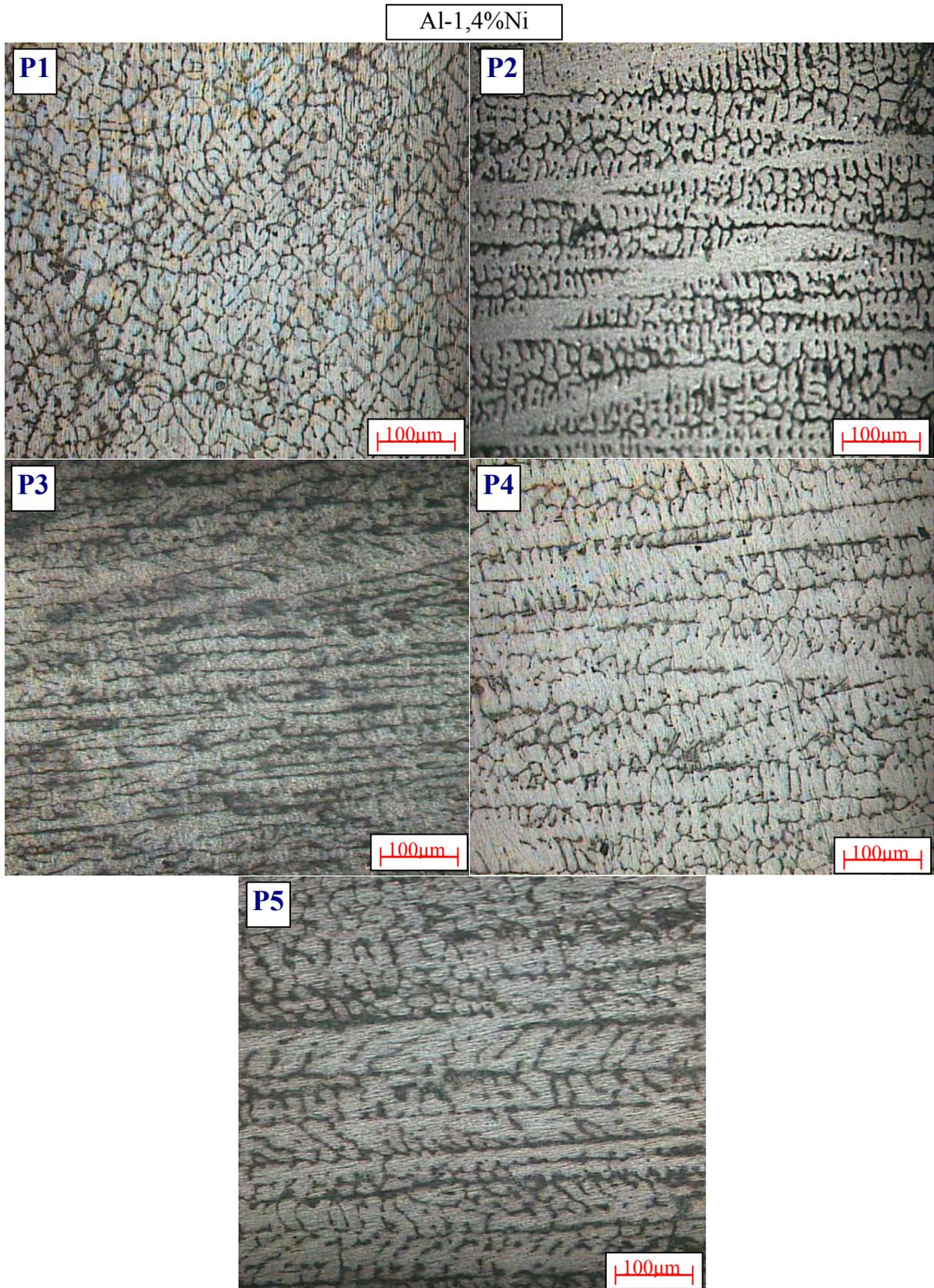
Figura 4.12 - Micrografias da Liga Al-1,4%Ni e respectivas posições relativas, com o mesmo aumento óptico (100 vezes), evidenciando o refino do espaçamento dendrítico secundário (barra de medida com 100µm).
