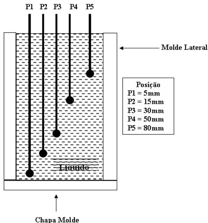
Figura 3.9 - Esquema representativo da localização dos termopares na massa fundida
