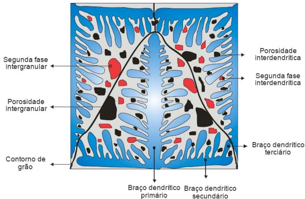
Figura 2.6 - Representação esquemática de microestrutura de fundidos (SANTOS, 2005).
