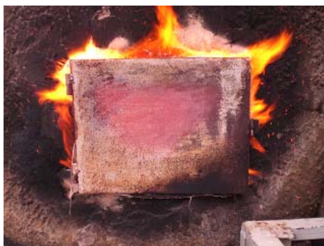
Figura 6-10 – Porta de vedação na janela de inspeção inferior durante um ensaio.
