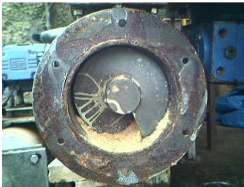
Figura 5-5 – Rosca sem-fim de alimentação de serragem.
