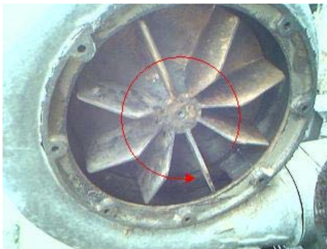
Figura 5-7 – Ventilador centrífugo do mecanismo de sucção.
