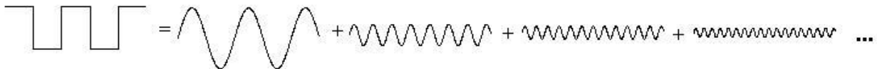
Figura 1. Ilustração do processo de composição de um sinal a partir de diferentes senóides puras
