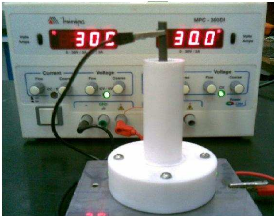
Figura 3.3: Plataforma experimental da célula eletroquímica construída no laboratório.
